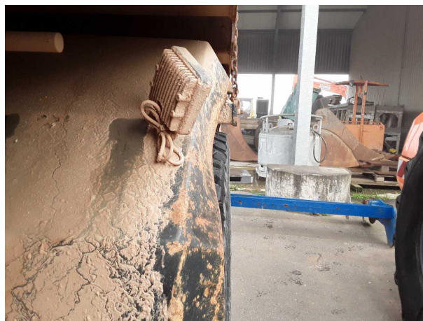
Beschädigung 1: Seitenwand links: Kotflügel hinten links - verformt - instandsetzen und lackieren
