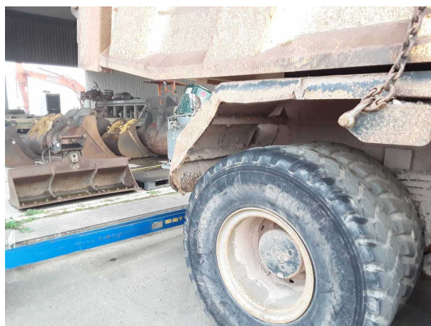
Beschädigung 6: Seitenwand rechts: Kotflügel hinten rechts - verformt - erneuern
