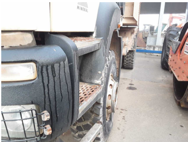
Beschädigung 4: Anbauteil links: Kotflügel vorn oberhalb - gebrochen / gerissen - erneuern
