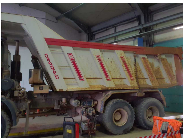
Beschädigung 5: Hinterkipper: Hinterkipper (PTO Schaltet nicht Hydraulik nicht angesteuert) - ohne Funktion - befunden
