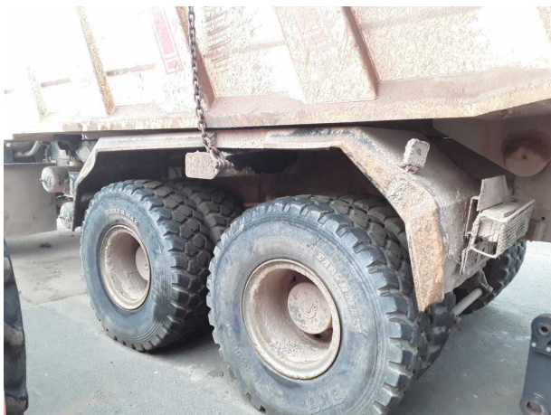
Beschädigung 1: Seitenwand links: Kotflügel hinten links - verformt - instandsetzen und lackieren
