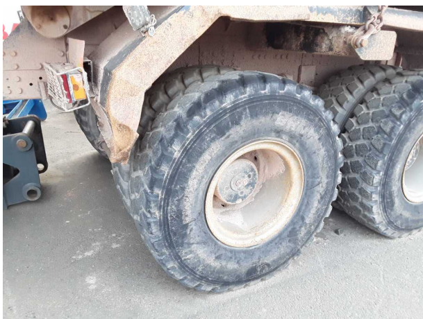
Beschädigung 11: Rad/Reifen: Reifen hinten (1HA und 2HA) - verschlissen - erneuern
