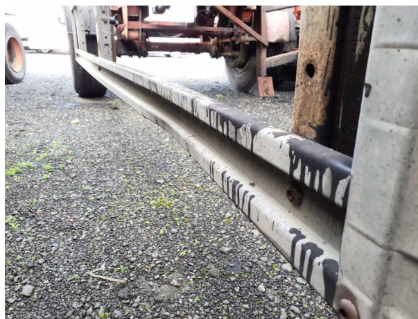
Gebrauchsspur 2: Anbauteil rechts: Unterfahrschutzprofil - verformt
