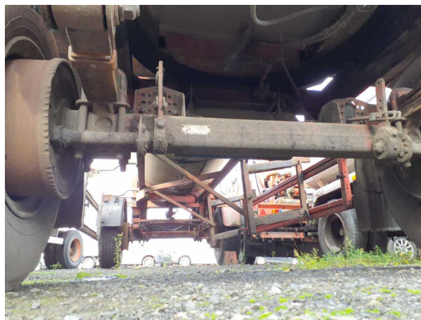
Beschädigung 3: Bremsanlage: Bremsanlage (Rückzugsfeder für Gestängesteller VR) - fehlt - erneuern
