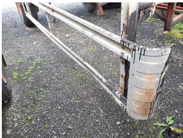
Gebrauchsspur 2: Anbauteil rechts: Unterfahrschutzprofil - verformt
