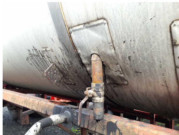
Beschädigung 12: Tankfahrzeug: Tankkammer (Isolierung u. Tank Kostenausweitung möglich) - undicht - instandsetzen
