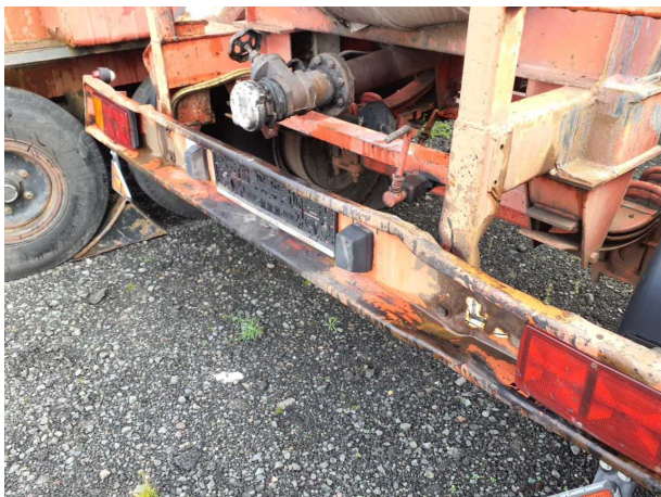
Beschädigung 5: Rahmen: Unterfahrschutz hinten (Laufleistung-/ Zeitgemässe Instandsetzung) - verformt -
