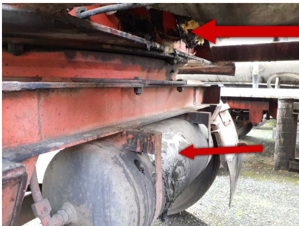
Beschädigung 11: Tankfahrzeug: Tankkammer (Dichtigkeit nicht bekannt und erstarrtes Bitumen im Tank) - reinigen
