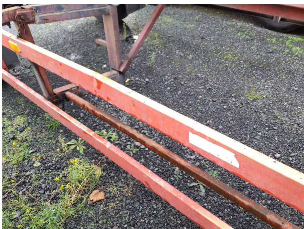
Gebrauchsspur 1: Anbauteil links: Unterfahrerschutzprofil - verformt
