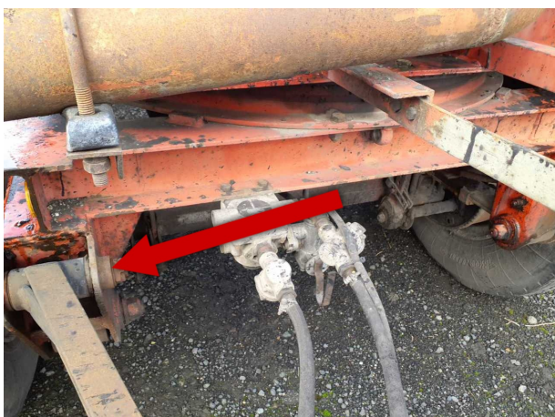
Beschädigung 6: Rahmen: Rahmen (Scherrenbolzen ausgeschlagen) - erneuern
