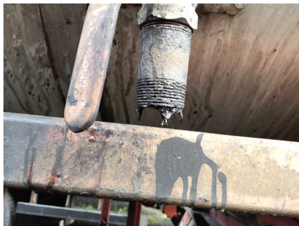
Beschädigung 11: Tankfahrzeug: Tankkammer (Dichtigkeit nicht bekannt und erstarrtes Bitummen im Tank) - reinigen
