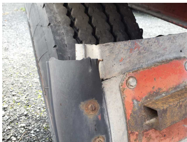
Beschädigung 4: Kotflügel links: Radhausverbreiterung - gebrochen / gerissen - erneuern
