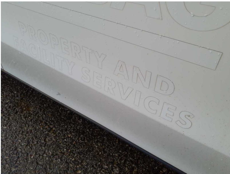
Beschädigung #1: Sonstiges: Fahrzeug (Kleberreste) - beklebt/ beschriftet - entkleben/neutralisieren
