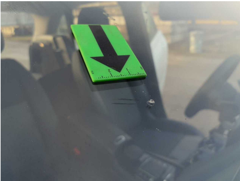
Beschädigung #2: Verglasung: Frontscheibe (Mit Rissbildung) - Steinschlag - erneuern
