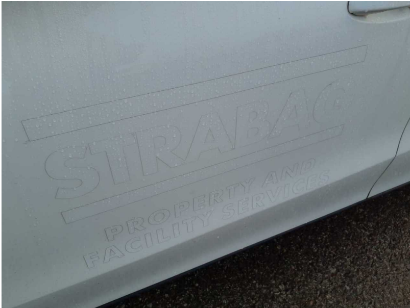
Beschädigung #1: Sonstiges: Fahrzeug (Kleberreste) - beklebt/ beschriftet - entkleben/neutralisieren
