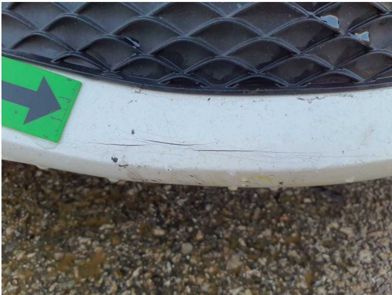
Beschädigung #4: Stossfänger vorn: Stossfänger vorn - gebrochen / gerissen - erneuern
