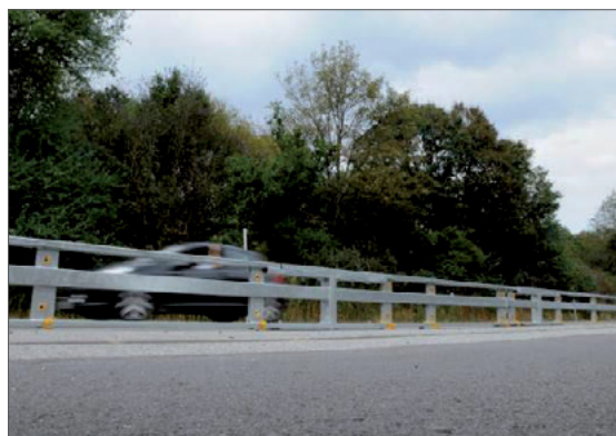
SafeGuard Pro 500 jako tymczasowe oddzielenie pasów kierunkowych na placu budowy.
