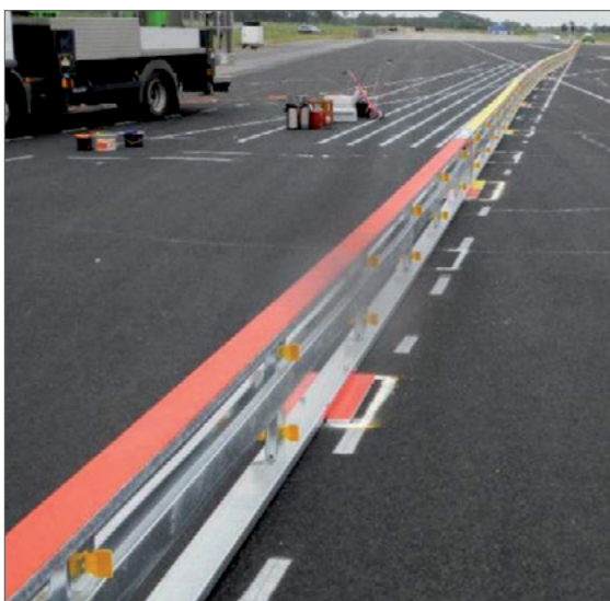
SafeGuard Pro 500 - nieprzerwana ciągłość elementów po teście uderzeniowym TB 21
