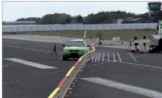
Test T1 TB 21 (samochód 1,3t, 80km/h, kąt 8°)
