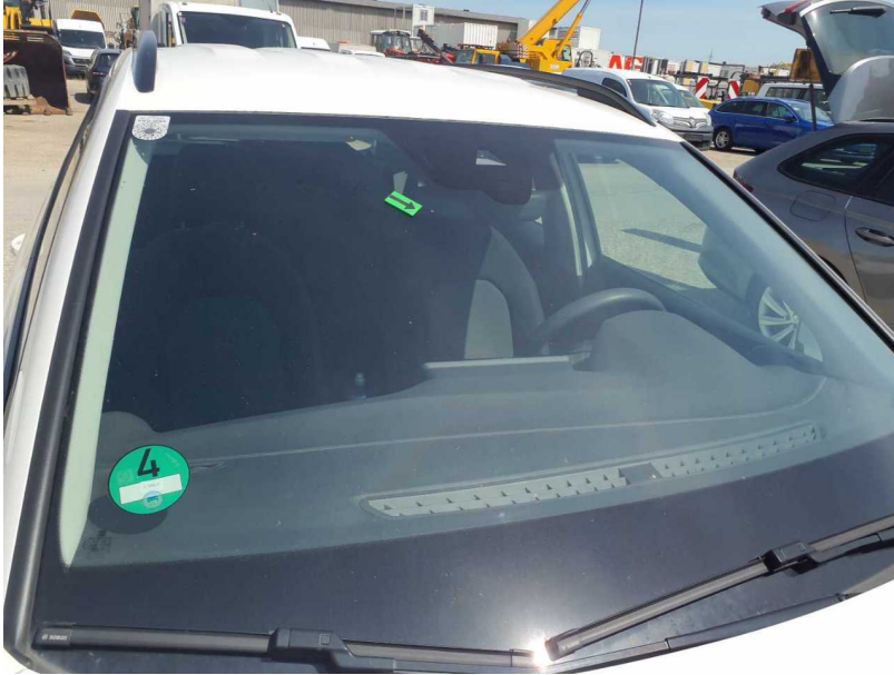
Beschädigung #4: Verglasung: Frontscheibe (Rissbildung) - Steinschlag - erneuern
