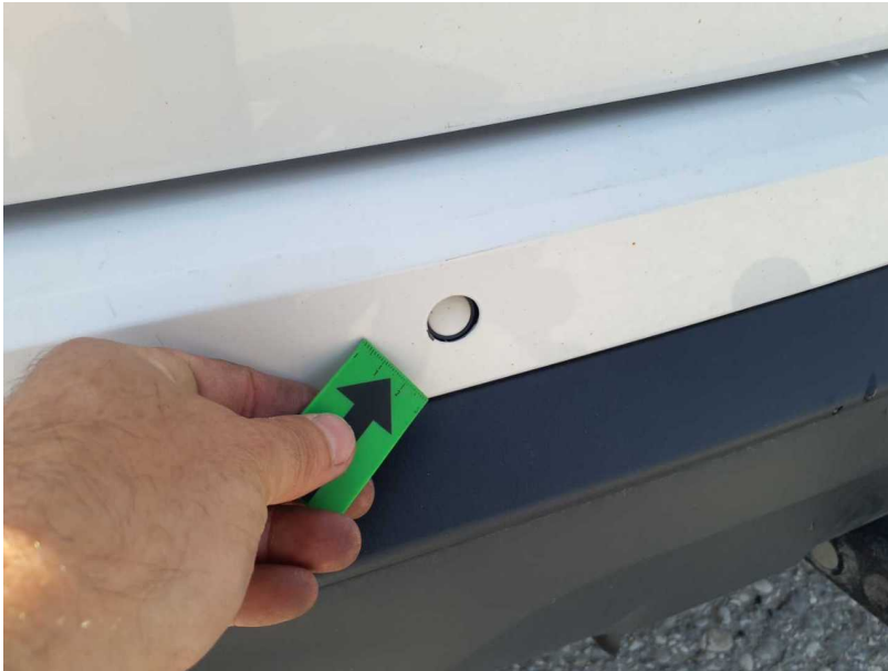
Beschädigung #1: Stossfänger hinten: Parksensoren Mitte - lose - instandsetzen
