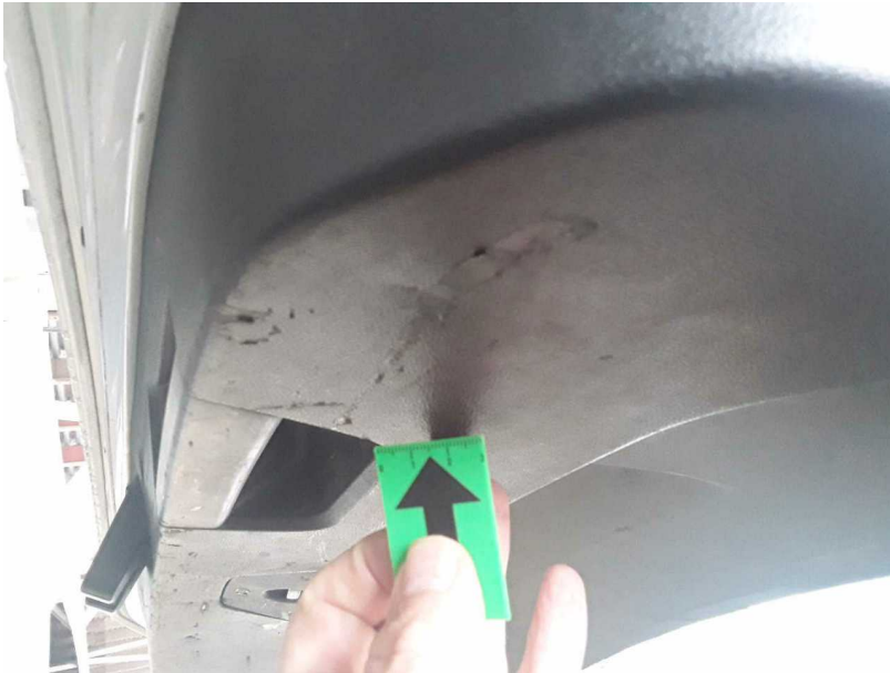
Beschädigung #1: Verkleidungen/Abdeckungen: Heckdeckel, Innenverkleidung - beschädigt - erneuern
