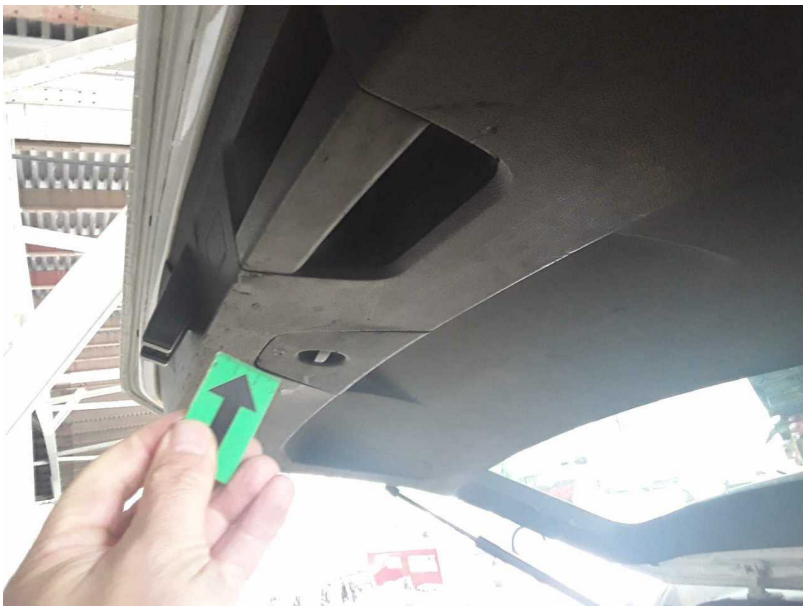
Beschädigung #1: Verkleidungen/Abdeckungen: Heckdeckel, Innenverkleidung - beschädigt - erneuern
