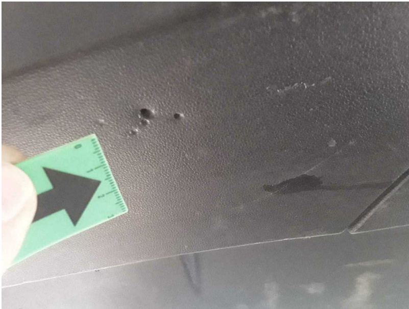
Beschädigung #1: Verkleidungen/Abdeckungen: Heckdeckel, Innenverkleidung - beschädigt - erneuern
