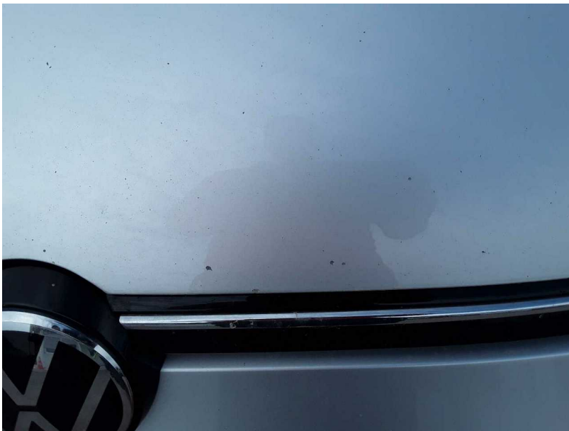
Beschädigung #2: Motorhaube: Motorhaube - Steinschlag - lackieren
