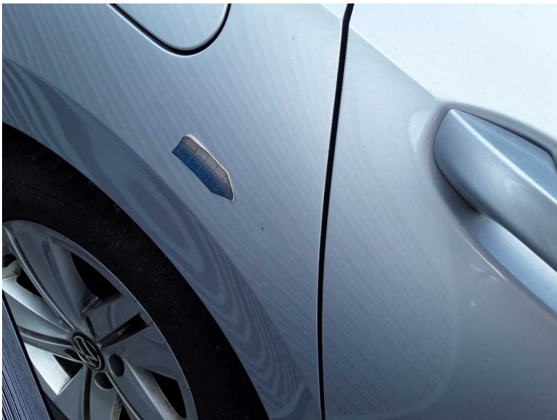
Beschädigung #1: Seitenwand rechts: Seitenwand - Delle / Lackschaden - instandsetzen und lackieren
