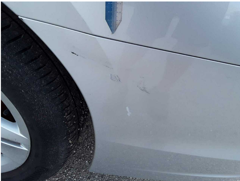
Beschädigung #3: Stossfänger hinten: Stossfänger hinten - beschädigt - erneuern
