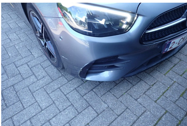
Beschädigung 2: Stossfänger vorn: Stossfänger vorn rechts (sierlijst) - verkratzt / verschürft - erneuern
