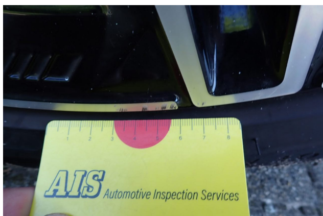
Gebrauchsspur 6: Rad/Reifen: Leichtmetallfelge hinten rechts - verkratzt / verschürft - kein Abzug
