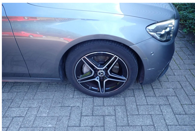
Beschädigung 5: Rad/Reifen: Leichtmetallfelge vorn rechts - verkratzt / verschürft - instandsetzen und lackieren
