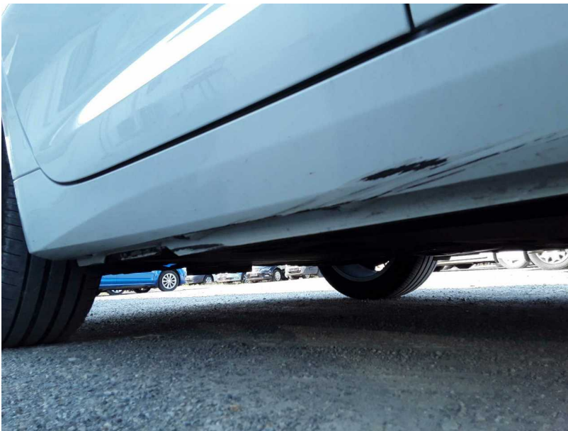
Beschädigung #2: Schweller rechts: Einstieg - beschädigt - erneuern
