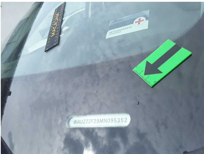
Beschädigung #3: Verglasung: Frontscheibe - gebrochen / gerissen - erneuern
