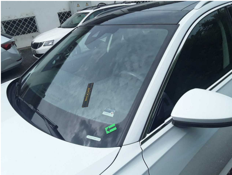
Beschädigung #3: Verglasung: Frontscheibe - gebrochen / gerissen - erneuern
