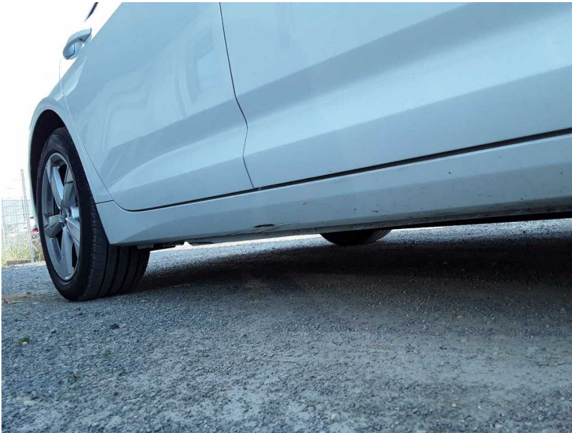
Beschädigung #2: Schweller rechts: Einstieg - beschädigt - erneuern
