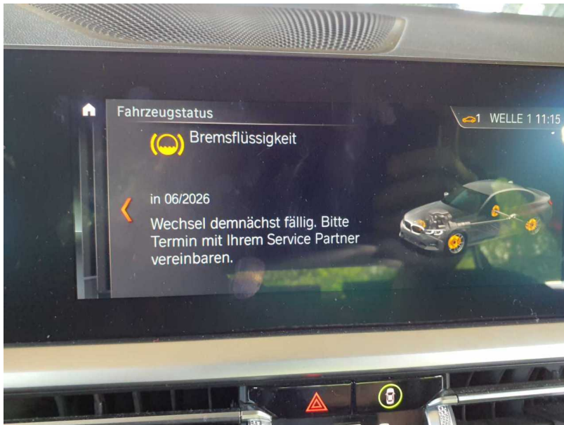
Beschädigung #2: Bremsanlage: Bremsflüssigkeit - abgelaufen - erneuern
