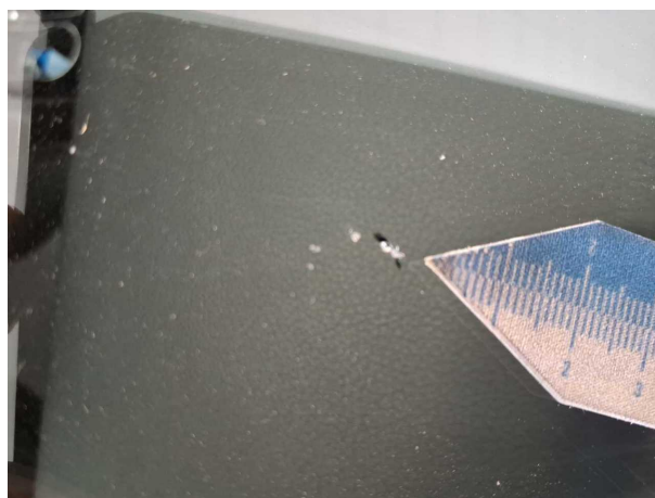
Beschädigung 2: Verglasung: Frontscheibe - gebrochen / gerissen - erneuern
