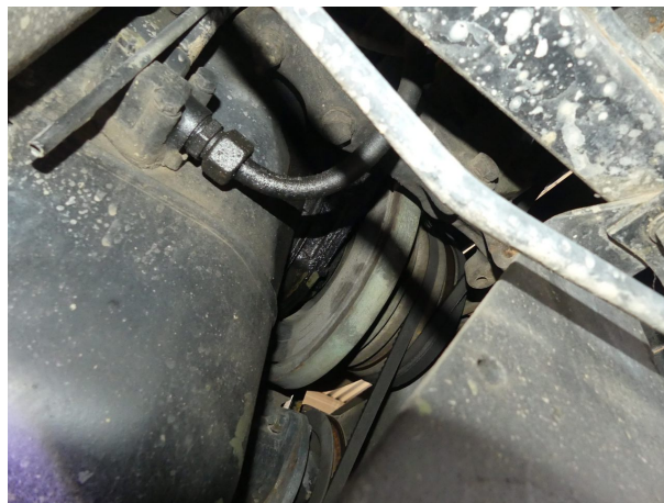
Beschädigung 13: Motor: Motor - undicht - befunden ggf. instandsetzen
