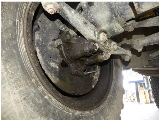
Beschädigung 8: Vorderachse: Radnabe rechts (Untersetzung) - undicht - instandsetzen
