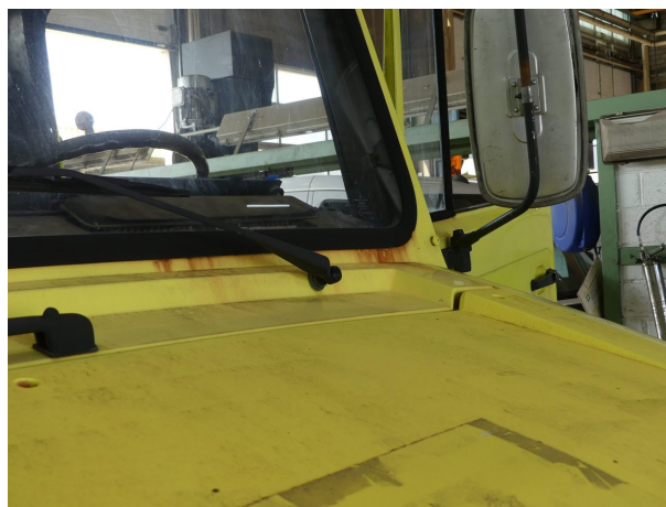
Beschädigung 7: Fahrerhaus: Fahrerhaus (Fensterrahmen) - Korrosion - instandsetzen und lackieren
