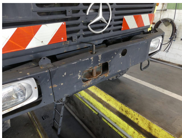
Gebrauchsspur 1: Stossfänger vorn: Stossfänger vorn - verformt
