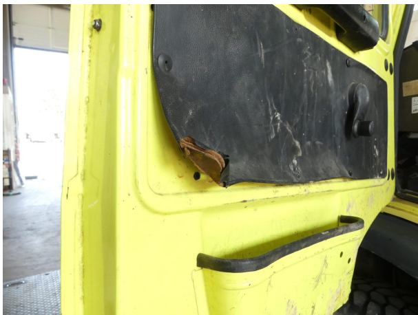
Beschädigung 4: Tür vorn links: Tür (Korrosion und Verkleidung löse) - instandsetzen
