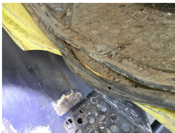
Beschädigung 3: Tür vorn links: Türdichtung - gebrochen / gerissen - erneuern
