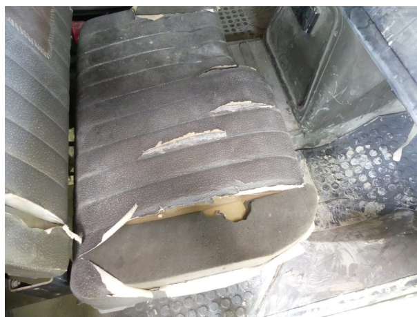
Beschädigung 14: Sitz vorn: Sitz links (und rechts) - verschlissen - erneuern
