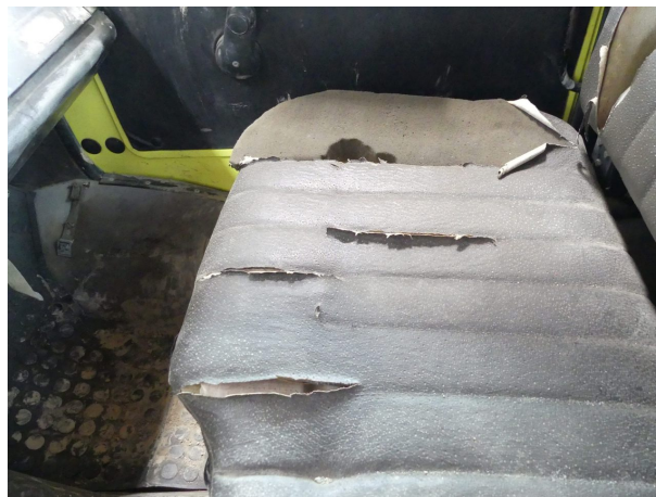
Beschädigung 14: Sitz vorn: Sitz links (und rechts) - verschlissen - erneuern
