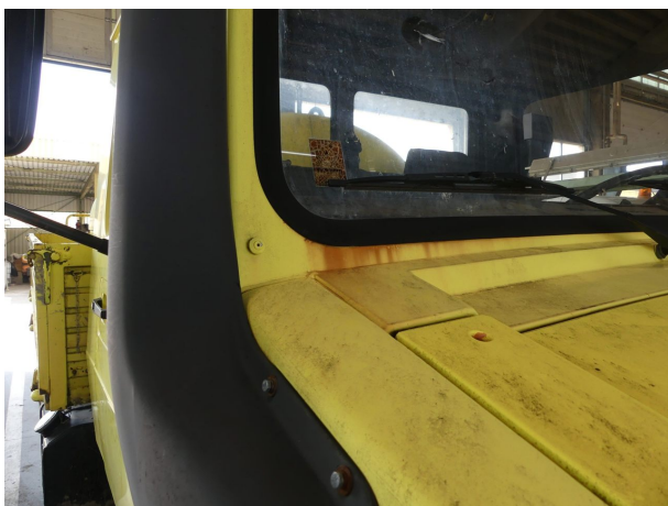
Beschädigung 7: Fahrerhaus: Fahrerhaus (Fensterrahmen) - Korrosion - instandsetzen und lackieren
