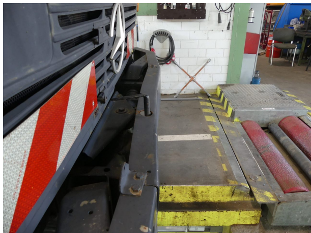
Gebrauchsspur 1: Stossfänger vorn: Stossfänger vorn - verformt
