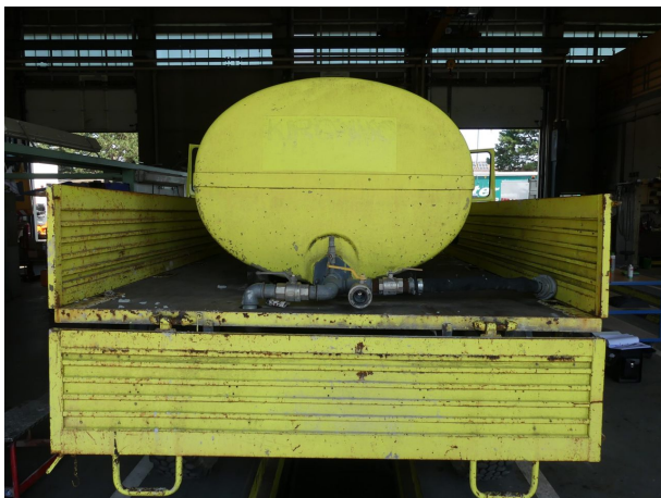
Beschädigung 12: Aufbau: Aufbau (Wasserpumpe) - fehlt - erneuern
