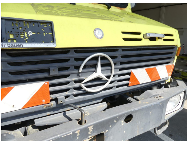
Beschädigung 2: Motorhaube: Emblem - gebrochen / gerissen - erneuern
