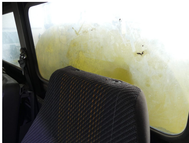
Fehlteil 1: Sitz vorn: Kopfstütze Sitz links - fehlt - erneuern
