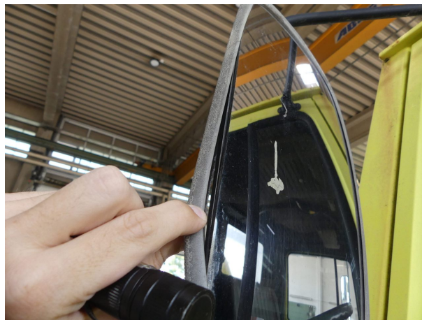
Beschädigung 1: Außenspiegel links: Außenspiegel - beschädigt - erneuern
