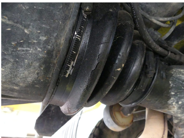
Beschädigung 11: Getriebe: Getriebe - undicht - befunden ggf. instandsetzen
