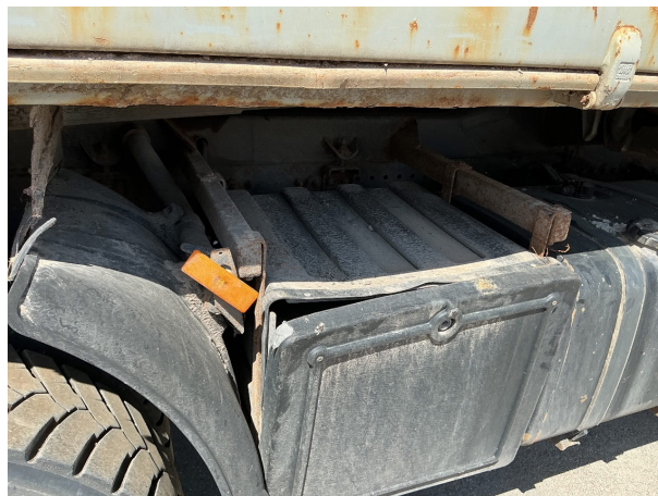
Beschädigung 2: Ausrüstung: Staufach - beschädigt - erneuern
