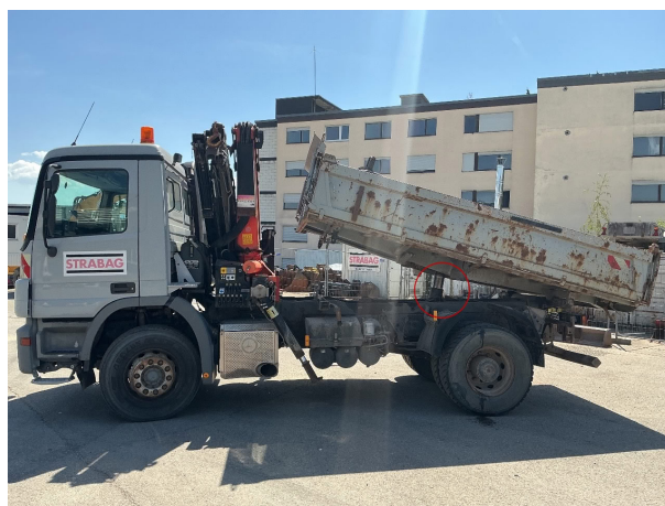
Beschädigung 4: Dreiseitenkipper: Presse - undicht - befunden ggf. instandsetzen
