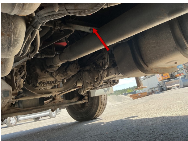
Beschädigung 4: Dreiseitenkipper: Presse - undicht - befunden ggf. instandsetzen
