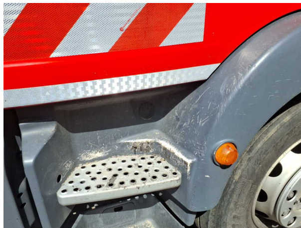
Gebrauchsspur 1: Anbauteil links: Einstieg oben - Kratzer
