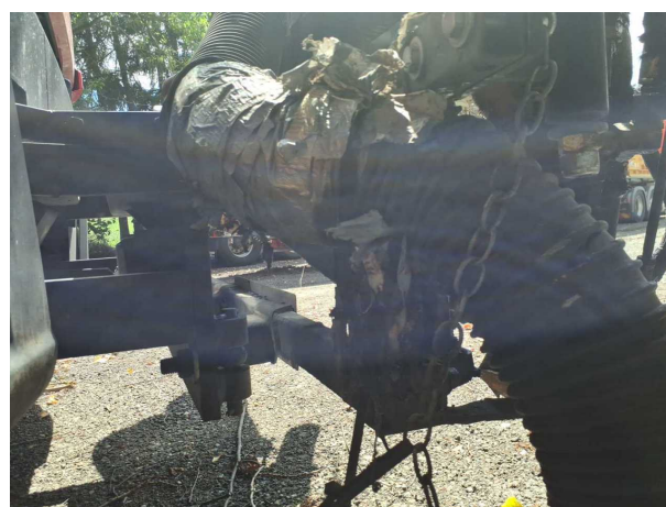
Beschädigung 3: Anbauteil rechts: Anbauteil (Frontarbeitsarm Schtzhülle) - beschädigt - erneuern
