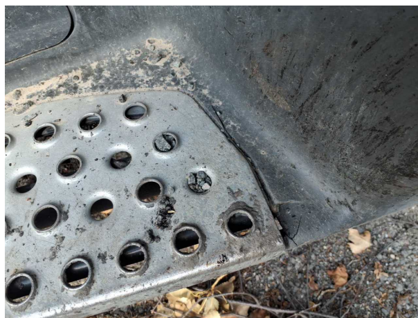
Beschädigung 1: Anbauteil links: Einstieg unten - gebrochen / gerissen - erneuern
