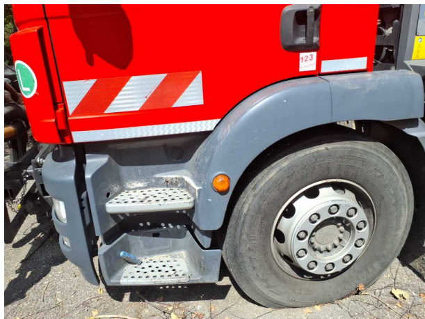
Gebrauchsspur 1: Anbauteil links: Einstieg oben - Kratzer
