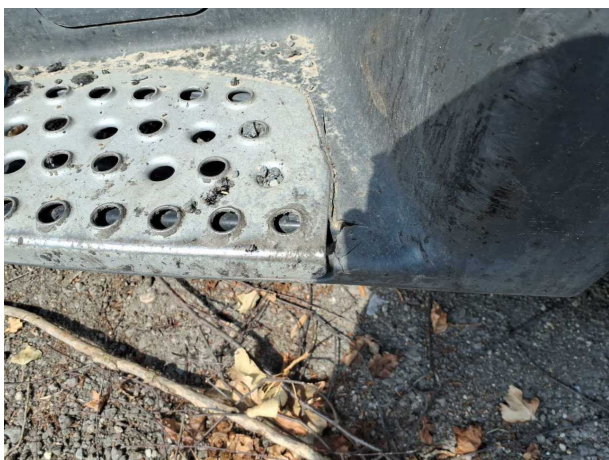
Beschädigung 1: Anbauteil links: Einstieg unten - gebrochen / gerissen - erneuern
