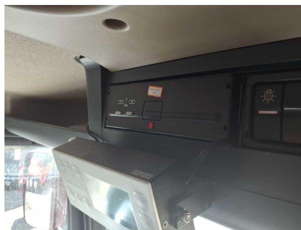
Beschädigung 4: elektrisches System: EG Kontrollgerät - unzulässig - erneuern
