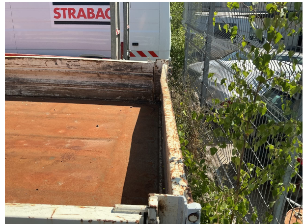
Beschädigung 2: Heckklappe/-tür: Heckklappe - verformt - instandsetzen
