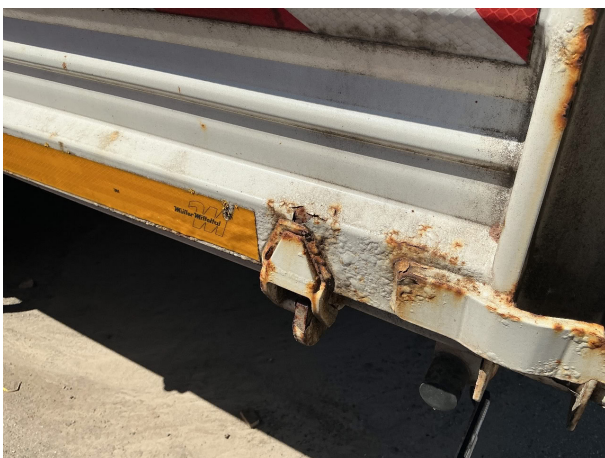
Beschädigung 5: Seitenwand rechts: Seitenwand - verformt - instandsetzen und lackieren
