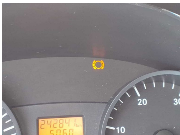
Beschädigung 3: Instrumententafel: Kontrollleuchte - leuchtet - entkleben/neutralisieren
