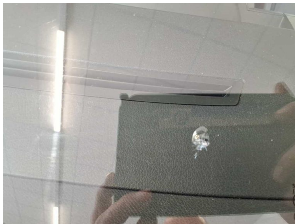
Beschädigung 5: Verglasung: Frontscheibe - gebrochen / gerissen - erneuern
