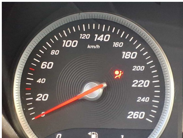
Beschädigung 1: Instrumententafel: Kontrollleuchte - leuchtet - Diagnose durchführen
