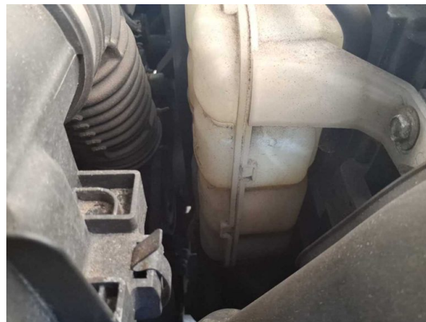
Beschädigung 2: Motorkühlung: Kühlflüssigkeit (Zu niedrig) - abweichend Auslieferungszustand - erneuern
