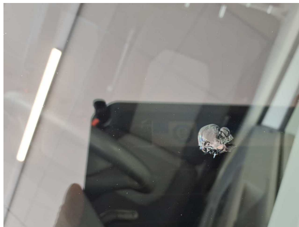
Beschädigung 3: Verglasung: Frontscheibe - gebrochen / gerissen - erneuern
