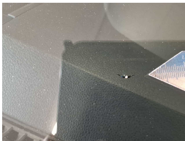
Beschädigung 3: Verglasung: Frontscheibe - gebrochen / gerissen - erneuern
