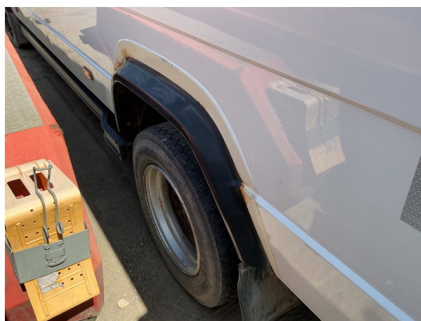
Beschädigung 5: Seitenwand links: Seitenwand - Korrosion - instandsetzen und lackieren
