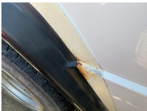
Beschädigung 5: Seitenwand links: Seitenwand - Korrosion - instandsetzen und lackieren
