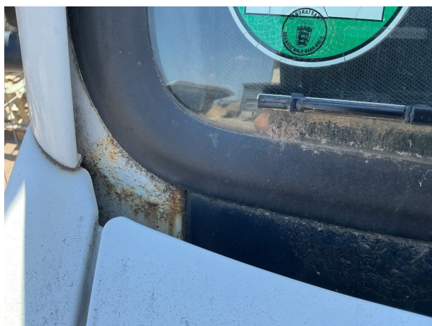
Beschädigung 4: Verglasung: Frontscheibe (Rahmen) - Korrosion - instandsetzen und lackieren
