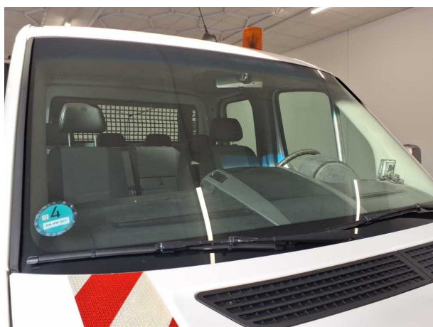
Beschädigung 4: Verglasung: Frontscheibe - gebrochen / gerissen - erneuern
