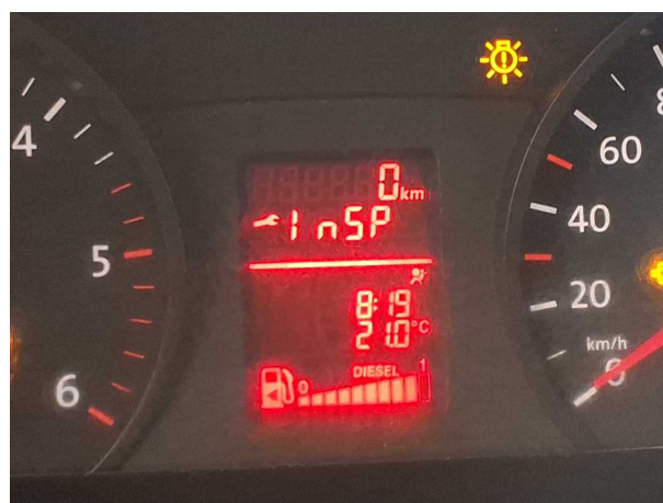
Beschädigung 3: Sonstiges: Inspektion/Wartung - fällig - durchführen
