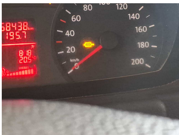
Beschädigung 2: Instrumententafel: Kontrollleuchte - leuchtet - Diagnose durchführen
