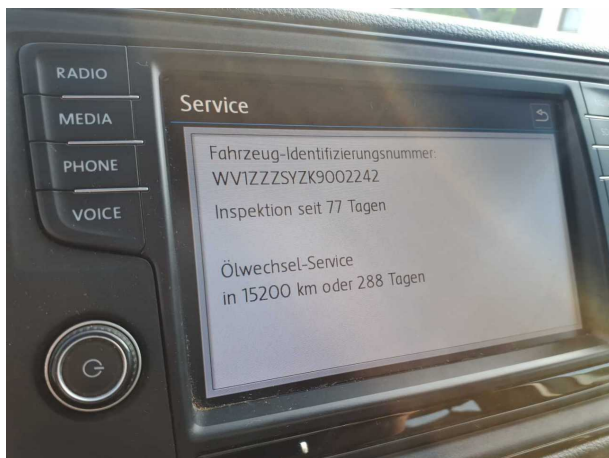
Beschädigung 4: Sonstiges: Inspektion/Wartung - fällig - durchführen
