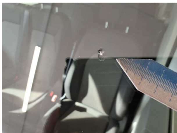
Beschädigung 5: Verglasung: Frontscheibe - gebrochen / gerissen - erneuern
