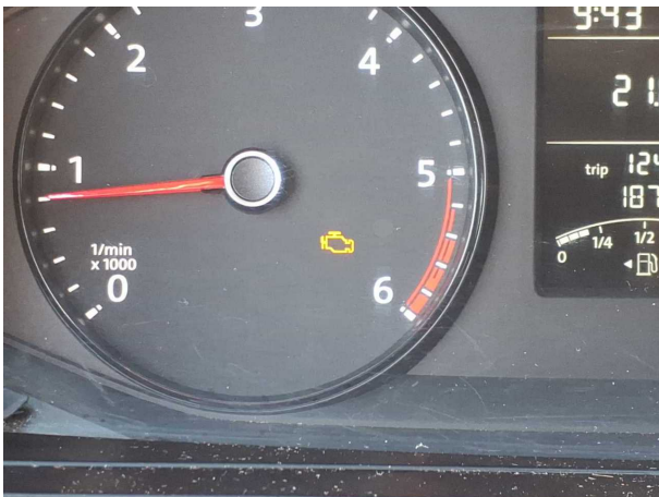
Beschädigung 1: Instrumententafel: Kontrollleuchte - leuchtet - Diagnose durchführen
