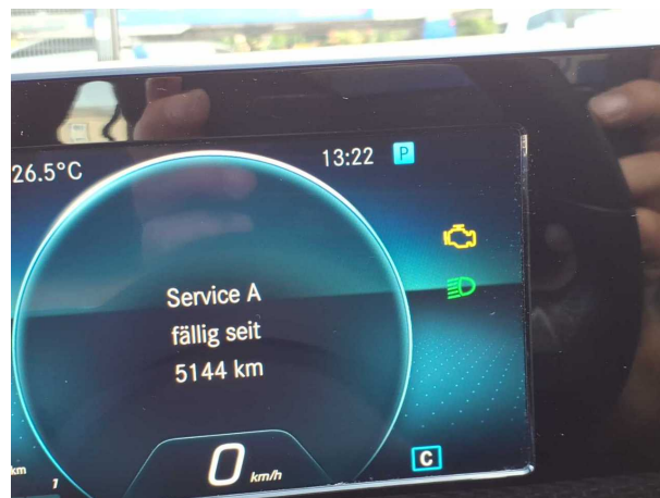
Beschädigung 1: Instrumententafel: Kontrollleuchte - leuchtet - Diagnose durchführen
