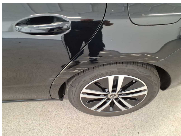
Beschädigung 3: Karosserie: Karosserie - beschädigt
