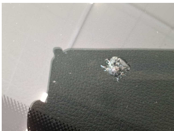
Beschädigung 3: Verglasung: Frontscheibe - gebrochen / gerissen - erneuern
