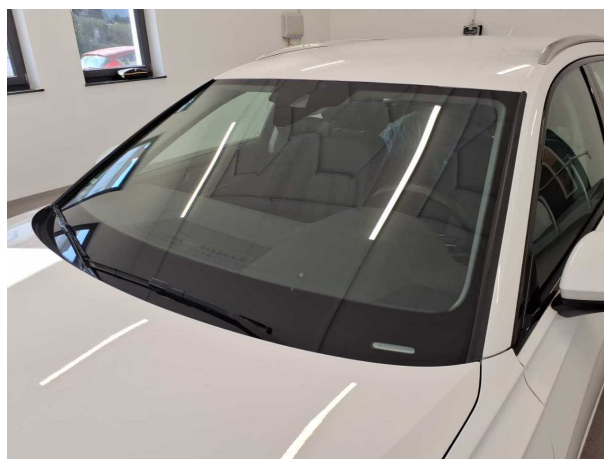
Beschädigung 3: Verglasung: Frontscheibe - gebrochen / gerissen - erneuern
