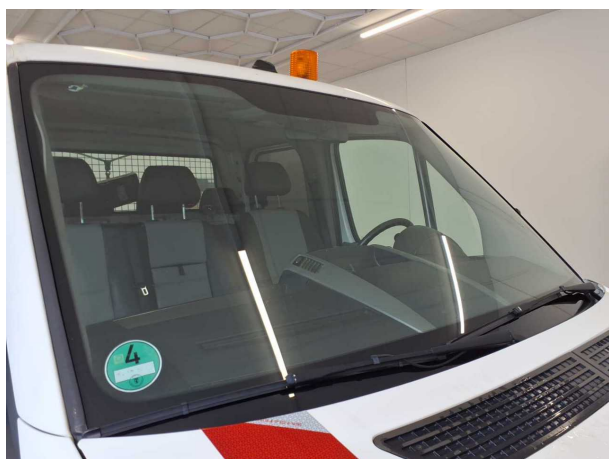
Beschädigung 3: Verglasung: Frontscheibe - gebrochen / gerissen - erneuern
