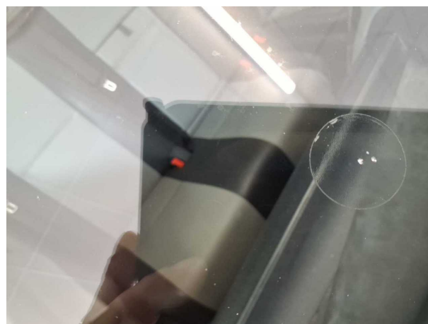
Beschädigung 3: Verglasung: Frontscheibe - gebrochen / gerissen - erneuern
