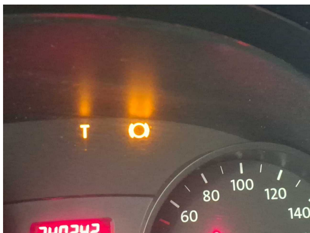
Beschädigung 2: Instrumententafel: Kontrollleuchte - leuchtet - Diagnose durchführen
