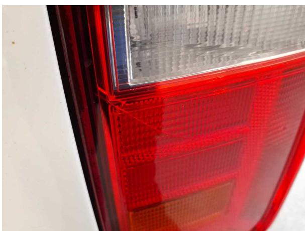
Beschädigung 4: elektrisches System: Lichtanlage (Rücklicht rechts) - beschädigt - erneuern
