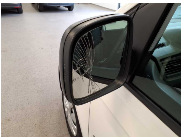
Beschädigung 3: Außenspiegel links: Spiegelglas (Links) - beschädigt - erneuern
