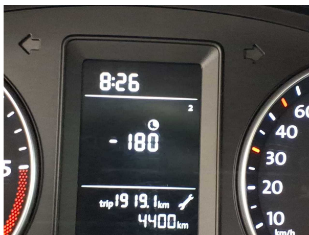
Beschädigung 5: Sonstiges: Inspektion/Wartung - fällig - erneuern
