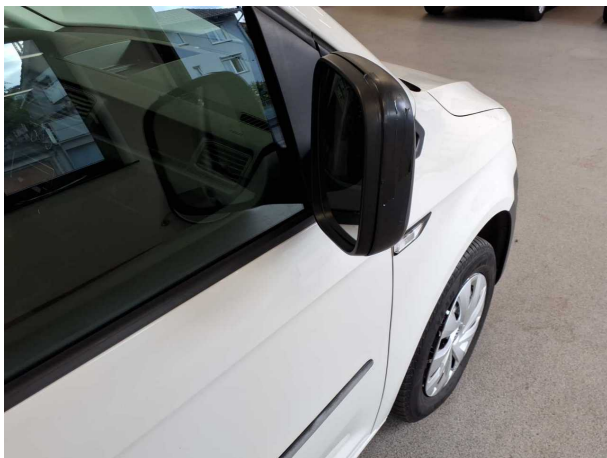
Beschädigung 1: Außenspiegel links: Abdeckkappe - beschädigt - erneuern
