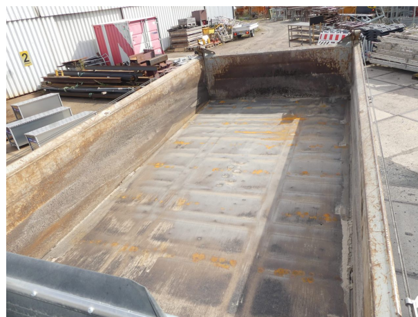
Beschädigung 6: Dreiseitenkipper: Kipperboden - verschlissen - erneuern
