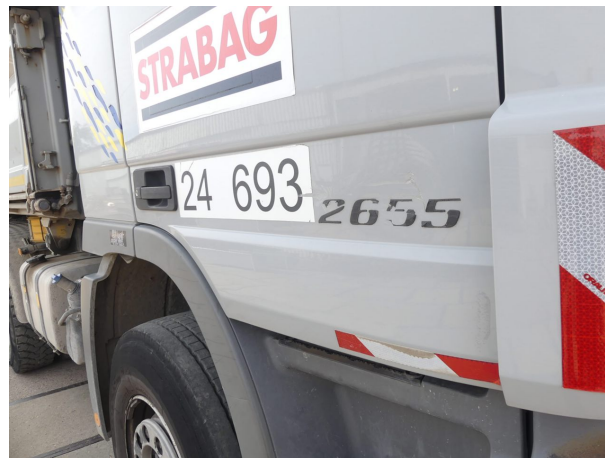
Beschädigung 4: Tür vorn links: Tür - verkratzt / verschürft - instandsetzen und lackieren
