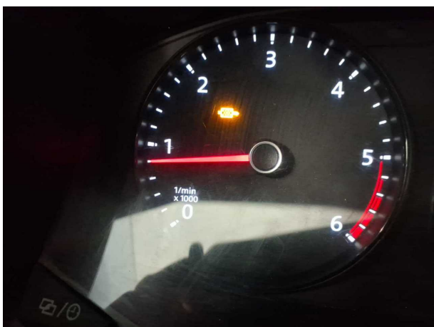
Beschädigung 3: Abgasanlage: Abgasanlage (Dpf) - beschädigt - Diagnose durchführen
