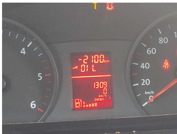
Beschädigung 5: Sonstiges: Inspektion/Wartung (Inkl. Zahnriemenwechsel, Mehrkosten möglich) - fällig - durchführen
