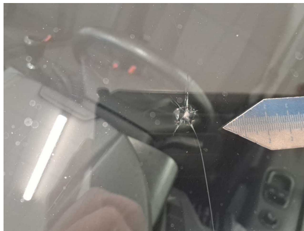
Beschädigung 4: Verglasung: Frontscheibe - gebrochen / gerissen - erneuern
