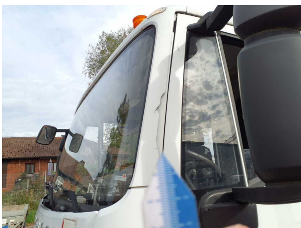
Beschädigung 10: Fahrerhaus: A-Säulenverkleidung links außen - gebrochen / gerissen - erneuern
