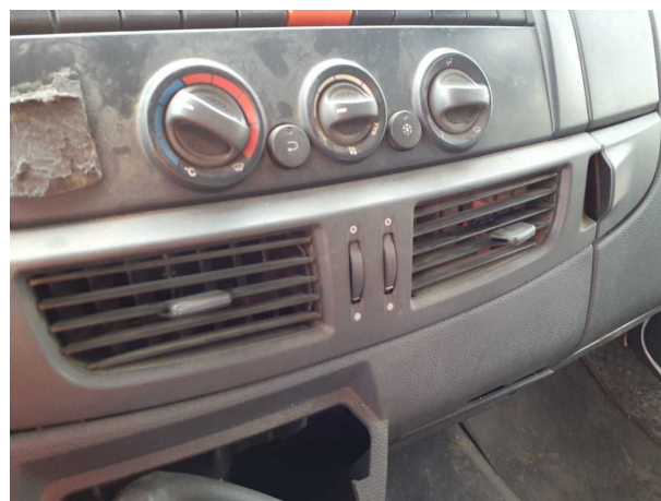
Beschädigung 8: Instrumententafel: Luftdüse Mitte - gebrochen / gerissen - erneuern
