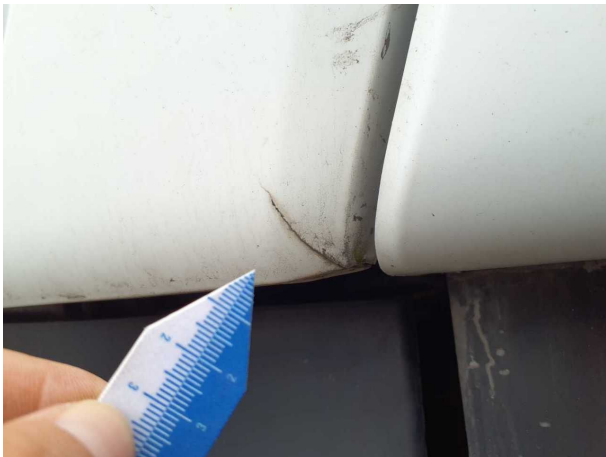
Beschädigung 14: Fahrerhaus: Frontklappe - gebrochen / gerissen - erneuern
