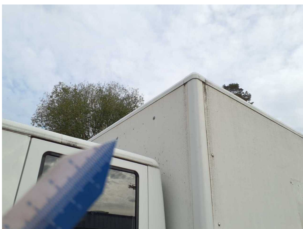
Beschädigung 7: Koffer: Stirnwand - Löcher - instandsetzen
