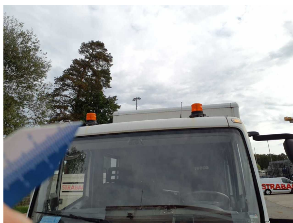
Beschädigung 6: Zusatzleuchte: Rundumleuchte (Blinkt nicht, leuchtet nur) - Teilfunktion - befunden ggf. instandsetzen
