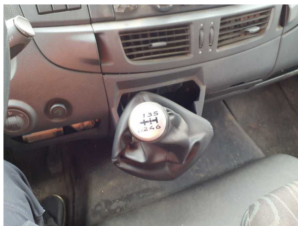
Beschädigung 2: Getriebe: Schaltmanschette - gebrochen / gerissen - erneuern
