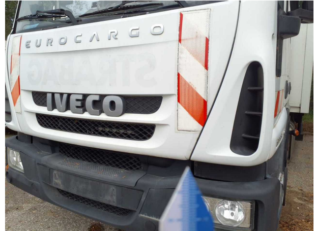
Beschädigung 14: Fahrerhaus: Frontklappe - gebrochen / gerissen - erneuern
