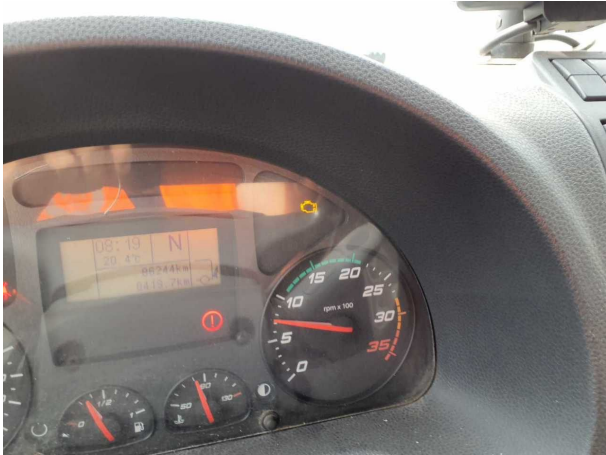
Beschädigung 11: Instrumententafel: Kontrollleuchte (Motorkontrolle, Folgekosten möglich) - leuchtet - befunden ggf.
