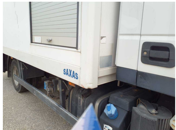
Gebrauchsspur 1: Karosserie: Eckbeplankung unterhalb rechts - verformt - aufbereiten
