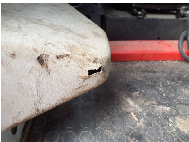
Beschädigung 1: Verkleidungen/Abdeckungen: B-Säule links Verkleidung innen - gebrochen / gerissen - erneuern
