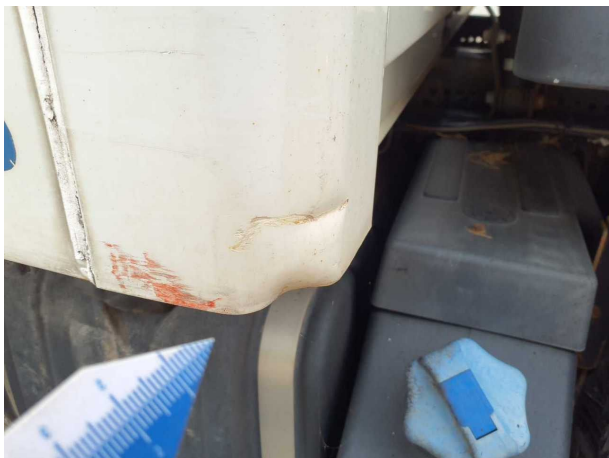
Gebrauchsspur 1: Karosserie: Eckbeplankung unterhalb rechts - verformt - aufbereiten
