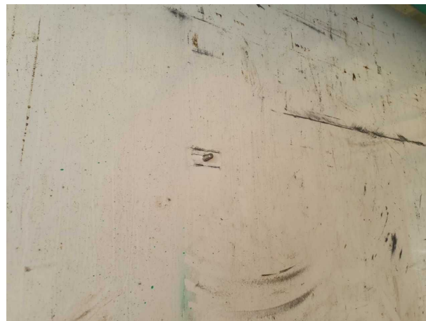
Beschädigung 3: Koffer: Seitenwand links - Löcher - instandsetzen
