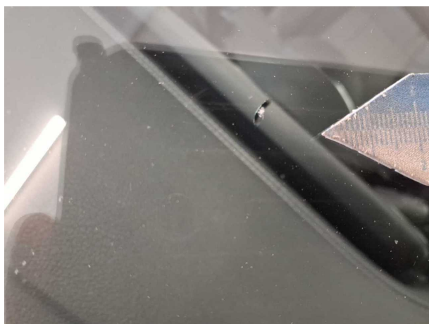
Beschädigung 2: Verglasung: Frontscheibe - gebrochen / gerissen - erneuern
