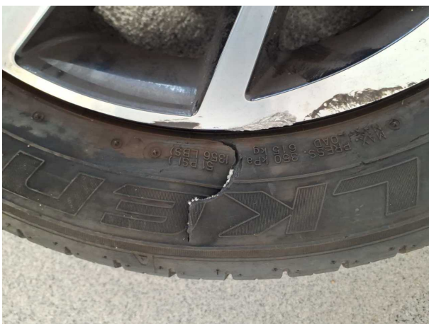
Beschädigung 1: Rad/Reifen: Reifen vorn links - beschädigt - erneuern
