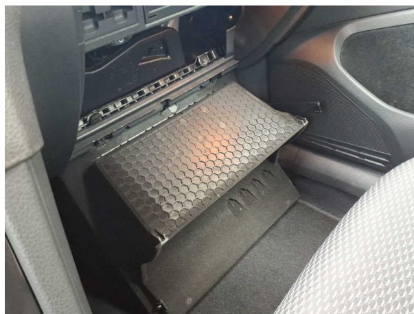
Beschädigung 1: Instrumententafel: Handschuhfachdeckel - beschädigt - erneuern
