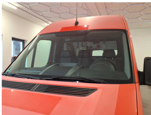
Beschädigung 5: Verglasung: Frontscheibe - gebrochen / gerissen - erneuern
