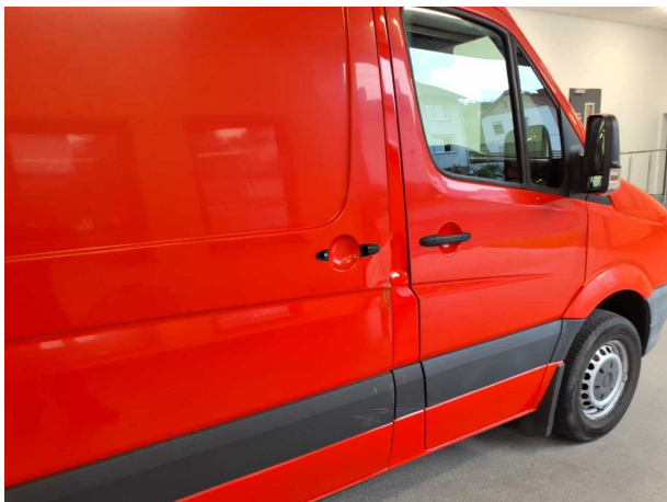
Beschädigung 2: Schiebetür rechts: Schiebetür (Griff , Mehrkosten möglich) - beschädigt - erneuern
