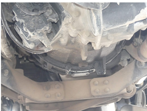
Beschädigung 11: Motor: Kurbelgehäusejoch (Getriebe) - undicht - instandsetzen
