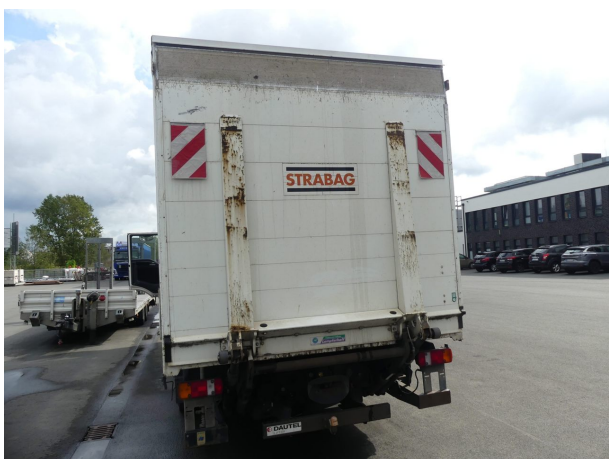
Beschädigung 10: Ladebordwand: Ladebordwand - gebrochen / gerissen - erneuern
