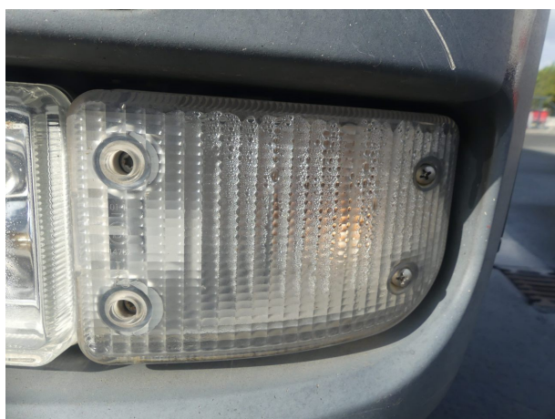
Beschädigung 3: Blinkleuchte: Blinkleuchte (links) - undicht - erneuern
