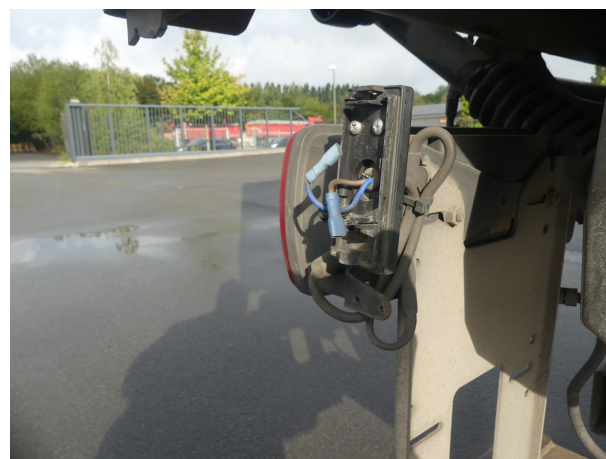
Beschädigung 2: Zusatzleuchte: Positionsleuchte rechts - gebrochen / gerissen - erneuern
