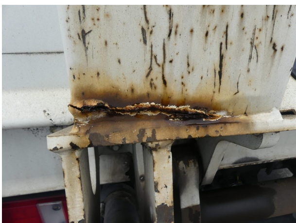
Beschädigung 10: Ladebordwand: Ladebordwand - gebrochen / gerissen - erneuern
