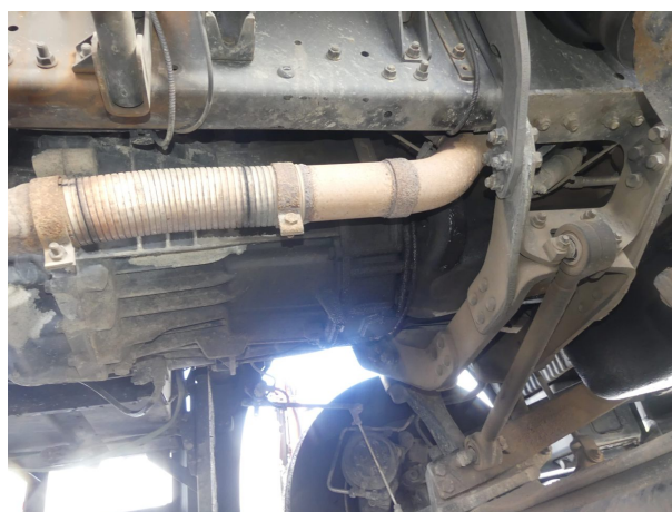
Beschädigung 11: Motor: Kurbelgehäusejoch (Getriebe) - undicht - instandsetzen
