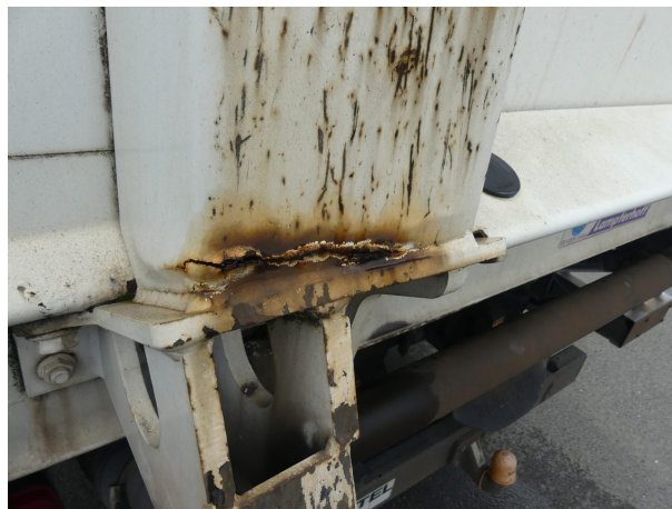
Beschädigung 10: Ladebordwand: Ladebordwand - gebrochen / gerissen - erneuern
