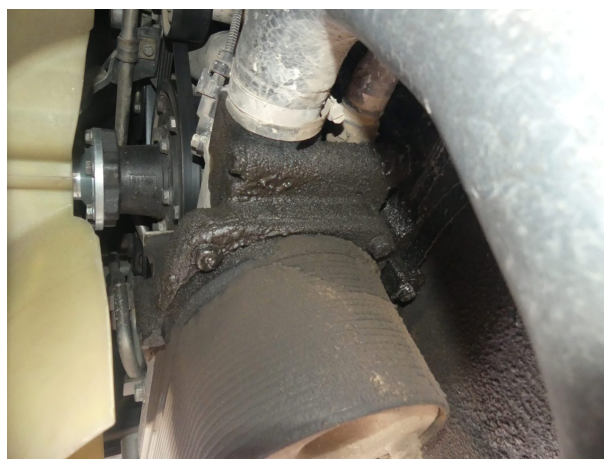
Beschädigung 11: Motor: Kurbelgehäusejoch (Getriebe) - undicht - instandsetzen
