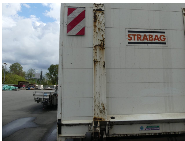
Beschädigung 10: Ladebordwand: Ladebordwand - gebrochen / gerissen - erneuern
