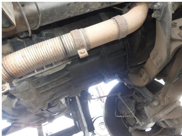
Beschädigung 11: Motor: Kurbelgehäusejoch (Getriebe) - undicht - instandsetzen
