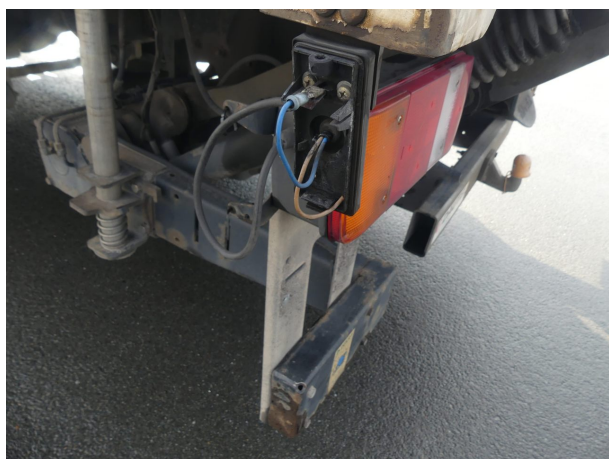
Beschädigung 1: Zusatzleuchte: Positionsleuchte links - gebrochen / gerissen - erneuern
