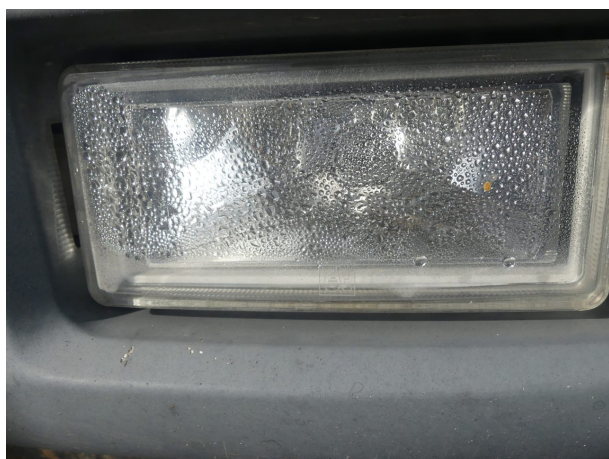
Beschädigung 6: Nebelleuchte: Nebelleuchte vorn links - undicht - erneuern
