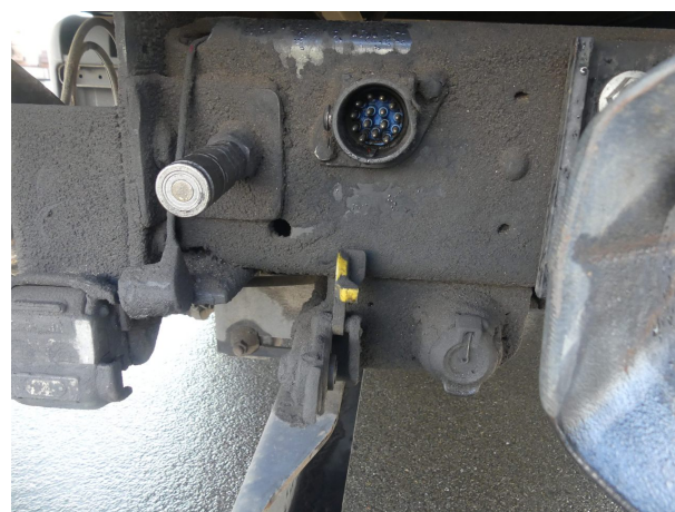
Beschädigung 4: Heckbereich: Anhängerdose - beschädigt - erneuern
