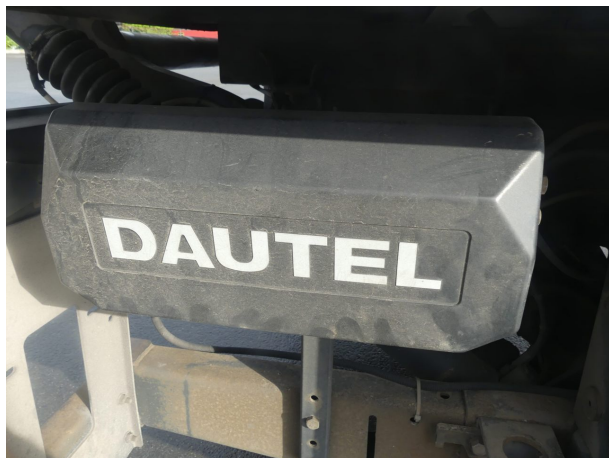
Beschädigung 5: Ladebordwand: Handbedienteil (Deckel) - gebrochen / gerissen - erneuern
