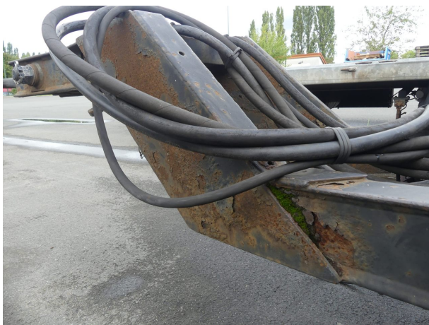
Beschädigung 1: Rahmen: Rahmen - Korrosion - instandsetzen und lackieren
