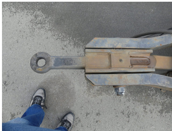
Beschädigung 1: Rahmen: Rahmen - Korrosion - instandsetzen und lackieren
