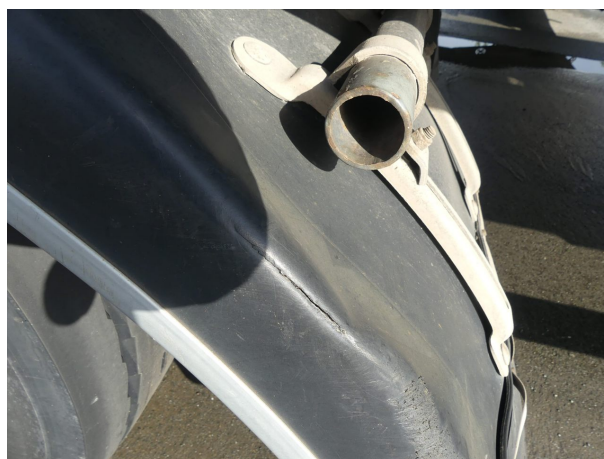
Beschädigung 5: Kotflügel links: Kotflügel links (vorn) - verformt - erneuern
