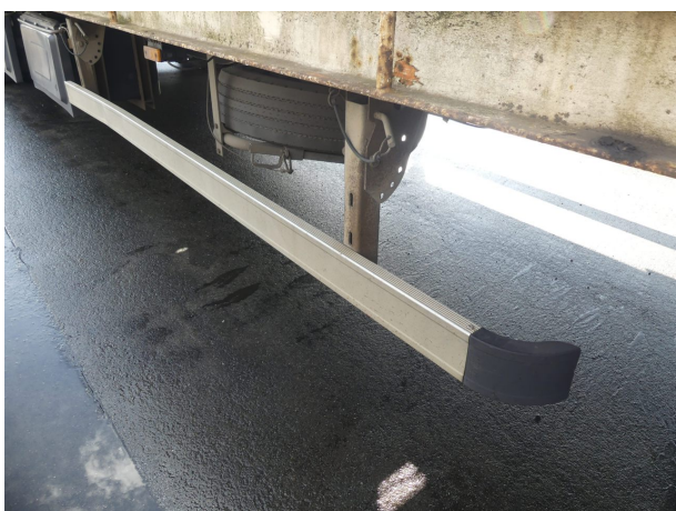
Gebrauchsspur 1: Rahmen: Rahmen (Unterfahrschutz) - verformt
