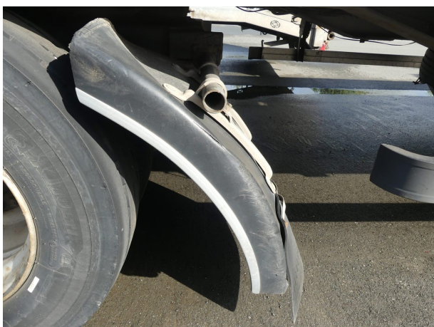
Beschädigung 5: Kotflügel links: Kotflügel links (vorn) - verformt - erneuern
