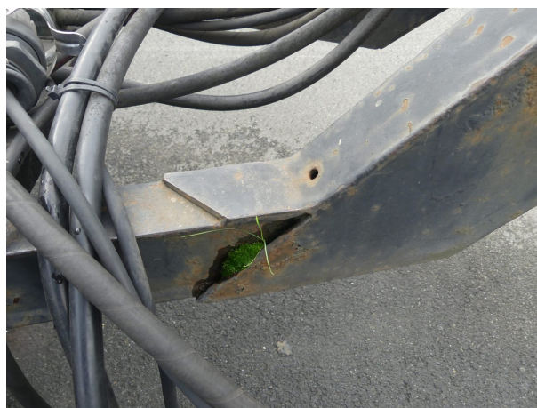
Beschädigung 1: Rahmen: Rahmen - Korrosion - instandsetzen und lackieren
