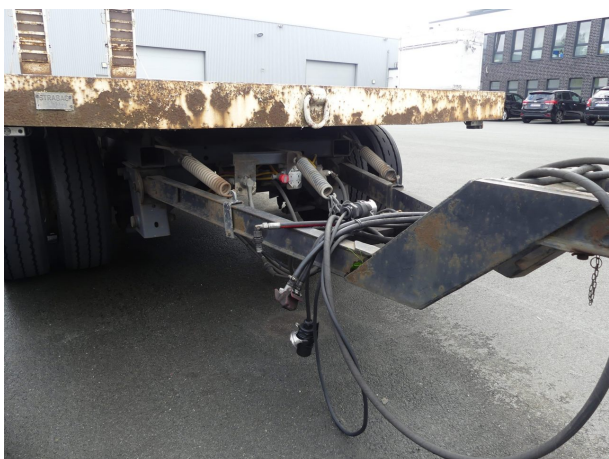
Beschädigung 1: Rahmen: Rahmen - Korrosion - instandsetzen und lackieren
