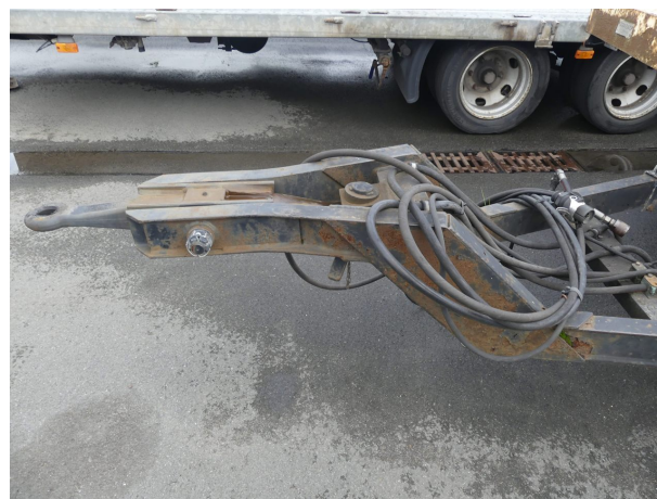
Beschädigung 1: Rahmen: Rahmen - Korrosion - instandsetzen und lackieren
