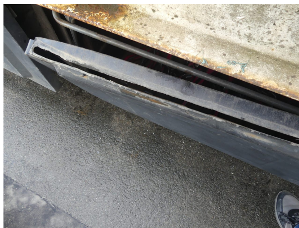
Beschädigung 4: Ausrüstung: Staufachdeckel - gebrochen / gerissen - erneuern
