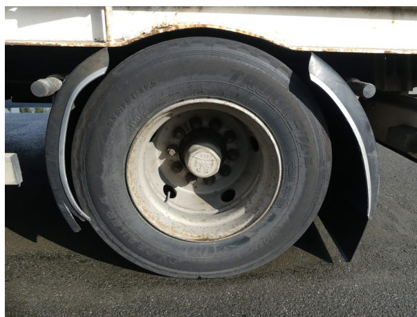
Beschädigung 8: Rahmen: Kotflügelabdeckung hinten links - verformt - erneuern
