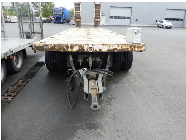
Beschädigung 1: Rahmen: Rahmen - Korrosion - instandsetzen und lackieren
