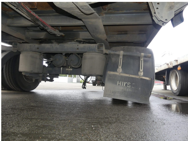
Beschädigung 6: Kotflügel rechts: Kotflügel rechts (vorn) - verformt - erneuern
