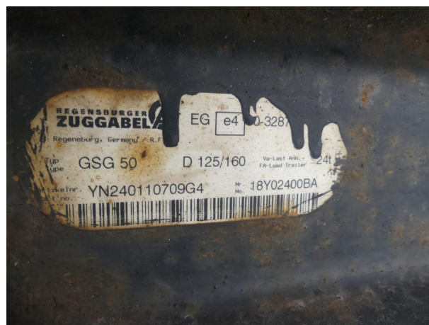
Beschädigung 1: Rahmen: Rahmen - Korrosion - instandsetzen und lackieren
