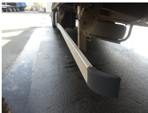
Gebrauchsspur 1: Rahmen: Rahmen (Unterfahrschutz) - verformt
