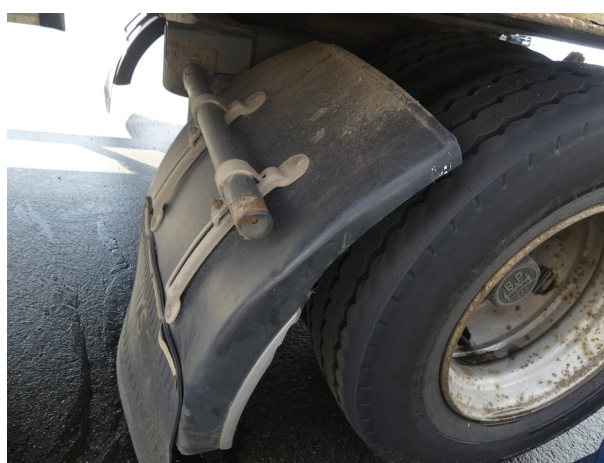
Beschädigung 6: Kotflügel rechts: Kotflügel rechts (vorn) - verformt - erneuern
