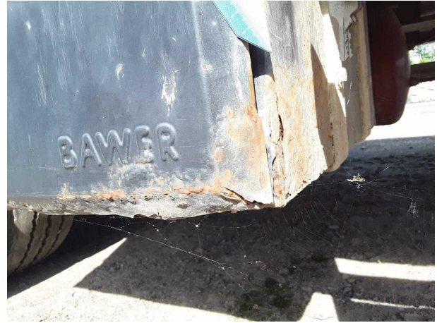
Beschädigung 4: Rahmen: Rahmen (Staukasten durchgerostet) - erneuern
