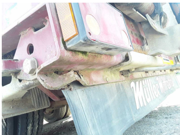
Beschädigung 3: Rahmen: Unterfahrschutz hinten - verformt - instandsetzen und lackieren
