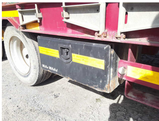
Beschädigung 4: Rahmen: Rahmen (Staukasten durchgerostet) - erneuern
