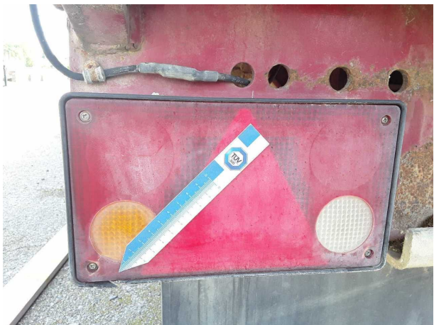
Beschädigung 1: Heckleuchte: Heckleuchte links - gebrochen / gerissen - erneuern
