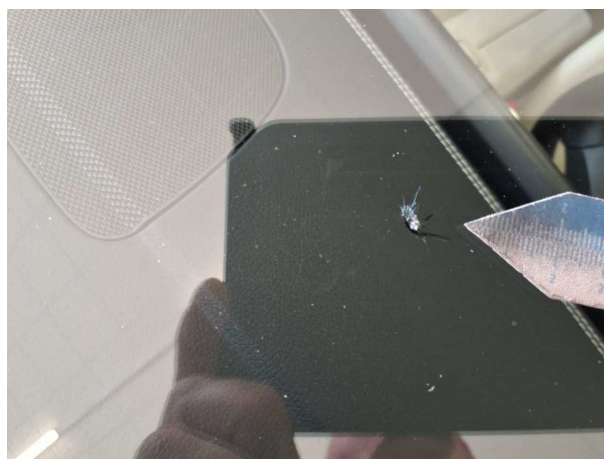
Beschädigung 2: Verglasung: Frontscheibe - gebrochen / gerissen - erneuern
