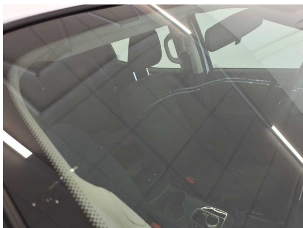
Beschädigung 2: Verglasung: Frontscheibe - gebrochen / gerissen - erneuern
