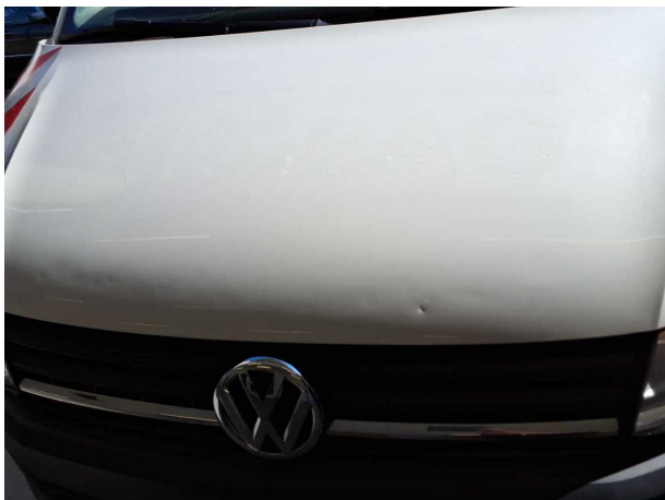
Beschädigung 4: Karosserie: Karosserie - beschädigt - Wertminderung
