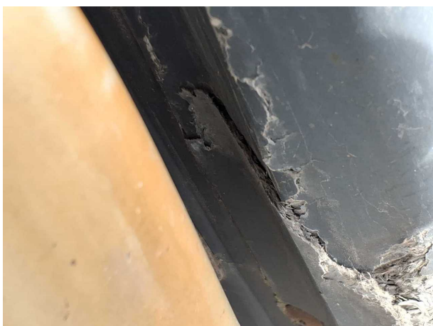
Beschädigung 3: Kotflügel rechts: Kotflügel rechts (Hinten) - gebrochen / gerissen - erneuern
