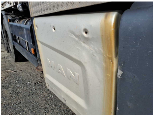
Beschädigung 4: Abgasanlage: Hitzeblech - verformt - erneuern
