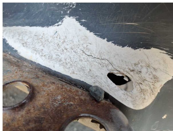
Beschädigung 5: Verkleidungen/Abdeckungen: Einstieg vorn links (Und Löcher) - gebrochen / gerissen - erneuern
