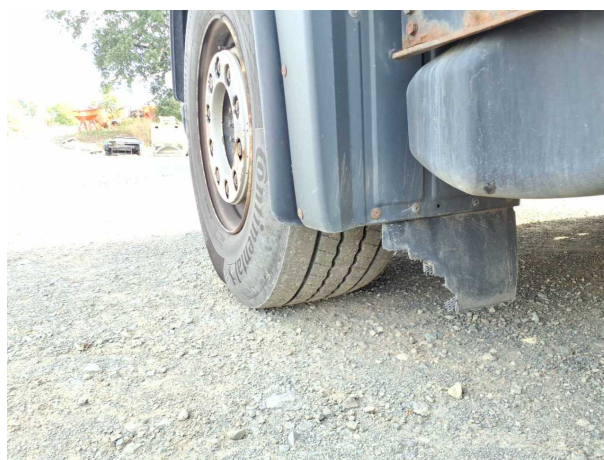
Beschädigung 1: Kotflügel links: Schmutzfänger - gebrochen / gerissen - erneuern
