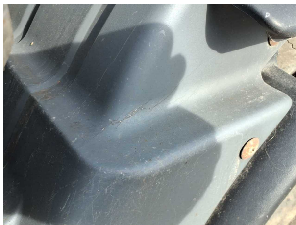
Beschädigung 3: Kotflügel rechts: Kotflügel rechts (Hinten) - gebrochen / gerissen - erneuern
