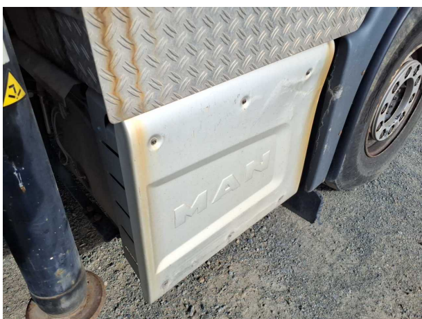
Beschädigung 4: Abgasanlage: Hitzeblech - verformt - erneuern
