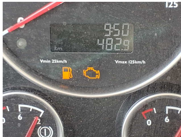
Beschädigung 8: Motor: Motor (Motorkontrolllampe leuchtet) - elektrischer Fehler - befunden ggf. instandsetzen
