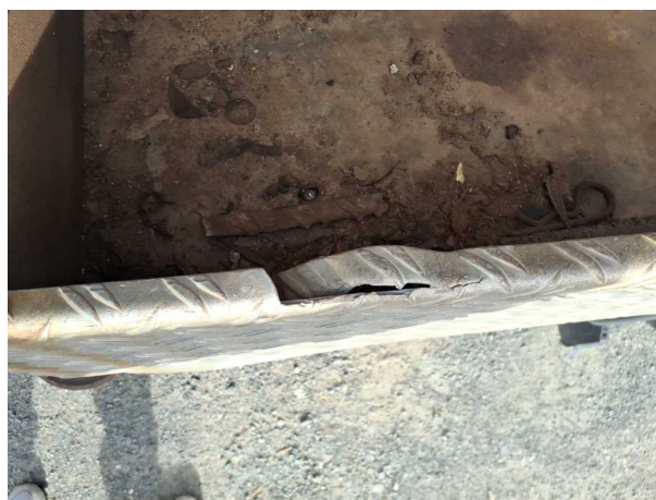
Beschädigung 2: Interieur: Ablagebox (Seite rechts Außen) - gebrochen / gerissen - instandsetzen
