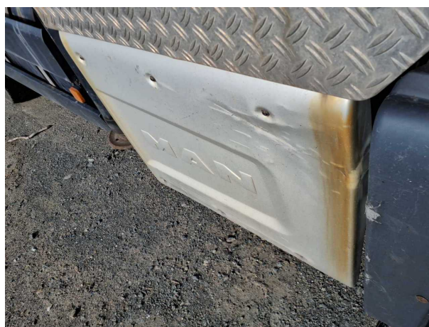
Beschädigung 4: Abgasanlage: Hitzeblech - verformt - erneuern
