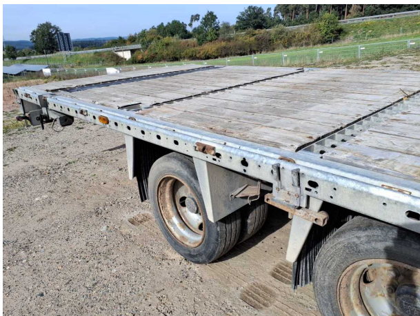
Beschädigung 7: Sonstiges: Fahrzeug (5x Ladebordwand) - fehlt - erneuern
