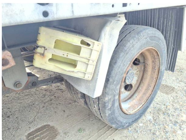
Beschädigung 3: Kotflügel links: Kotflügel links (Hinten) - verformt - erneuern
