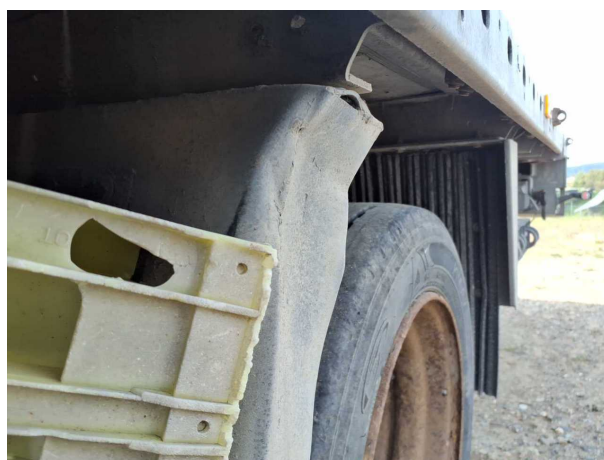
Beschädigung 3: Kotflügel links: Kotflügel links (Hinten) - verformt - erneuern
