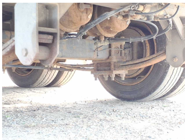
Beschädigung 6: Sonstiges: Bremsen Service (mit Radlager fetten) - durchführen
