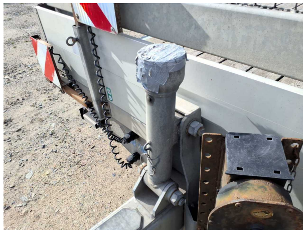
Beschädigung 1: Sonstiges: Fahrzeug (Abdeckung Deichsel Höhenverstellung) - gebrochen / gerissen - erneuern
