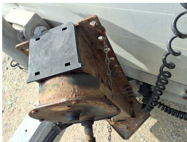
Beschädigung 5: Sonstiges: Fahrzeug (Stützbein , und Korrosion) - verformt - erneuern
