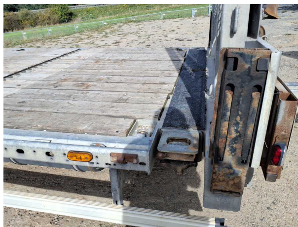
Beschädigung 7: Sonstiges: Fahrzeug (5x Ladebordwand) - fehlt - erneuern
