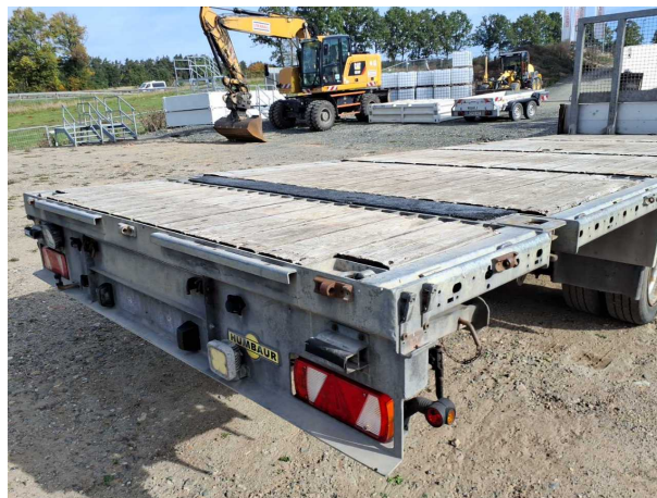
Beschädigung 7: Sonstiges: Fahrzeug (5x Ladebordwand) - fehlt - erneuern
