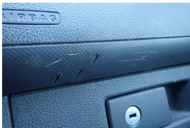
Beschädigung 4: Instrumententafel: Mittelkonsole vorn - Kratzer - erneuern
