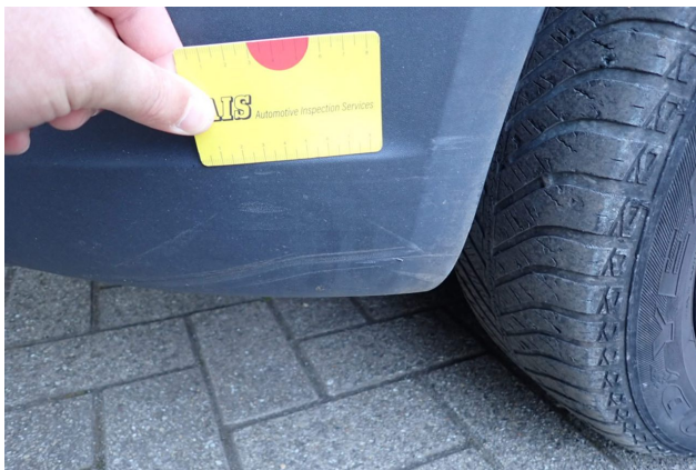
Beschädigung 1: Stossfänger vorn: Stossfänger vorn (unlackiert) - verkratzt / verschürft - erneuern
