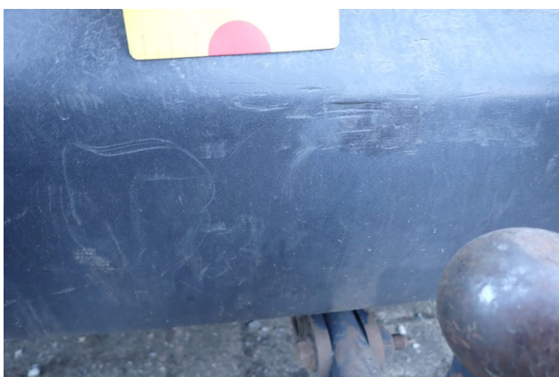
Beschädigung 2: Stossfänger hinten: Stossfänger hinten (unlackiert) - verkratzt / verschürft - erneuern
