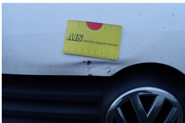
Beschädigung 7: Motor: Motorabdeckung - Delle / Lackschaden - instandsetzen und lackieren
