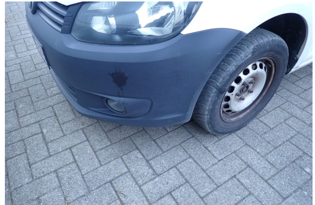
Beschädigung 1: Stossfänger vorn: Stossfänger vorn (unlackiert) - verkratzt / verschürft - erneuern
