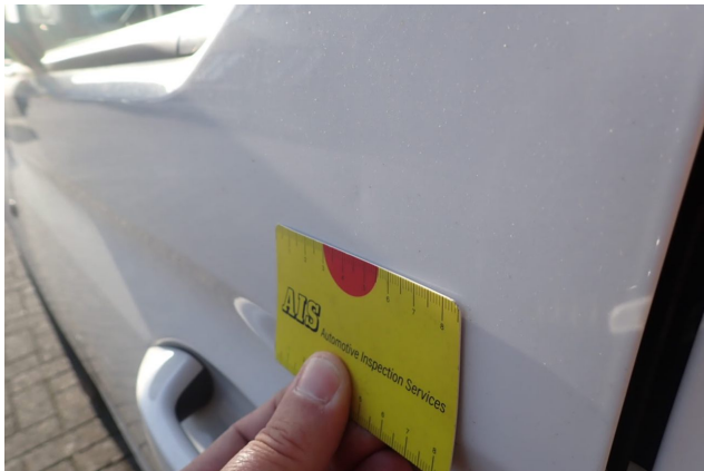
Beschädigung 1: Tür vorn links: Tür - Delle(n) - sanft instandsetzen
