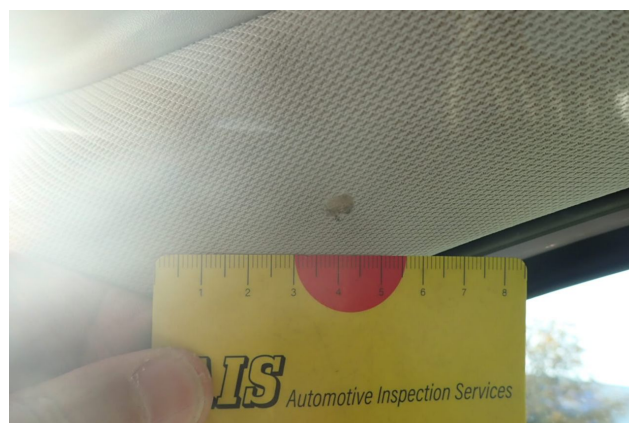
Beschädigung 5: Karosserie: A-Säule rechts - Brandloch - erneuern
