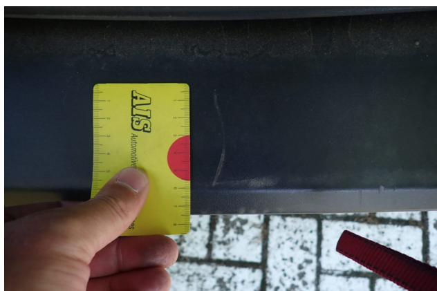
Beschädigung 3: Stossfänger hinten: Stossfänger hinten (unlackiert) - verkratzt / verschürft - erneuern
