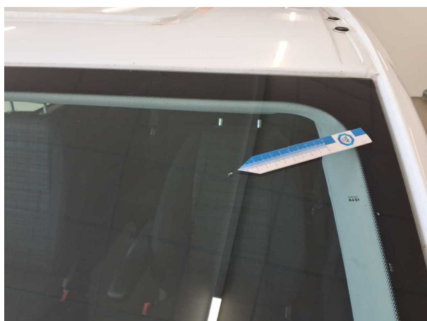
Beschädigung 1: Verglasung: Frontscheibe - gebrochen / gerissen - erneuern
