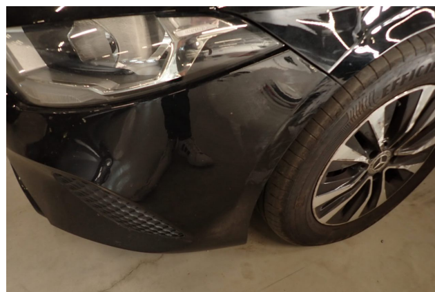
Beschädigung 8: Stossfänger vorn: Stossfänger vorn - verkratzt / verschürft - instandsetzen und lackieren
