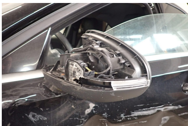
Beschädigung 5: Blinkleuchte: Spiegel links - verkratzt / verschürft - erneuern
