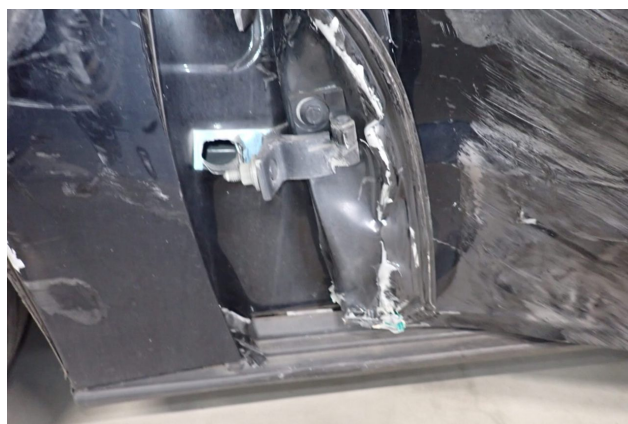
Beschädigung 4: Vermessung: Fahrzeugrahmen - verformt - instandsetzen und lackieren
