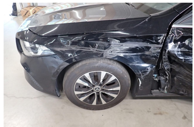
Beschädigung 1: Kofflülge links: Kofflülge links - Delle / Lackschaden - erneuern
