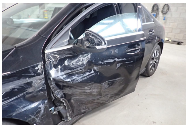
Beschädigung 3: Tür vorn links: Tür - Delle / Lackschaden - erneuern
