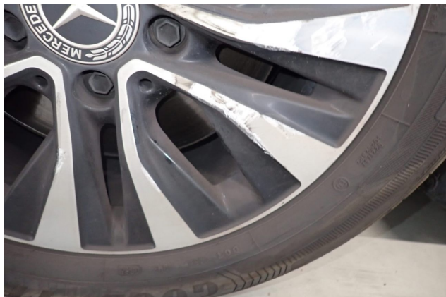
Beschädigung 2: Rad/Reifen: Leichtmetallfelge vorn links - verkratzt / verschürft - erneuern
